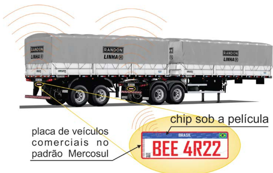
Figura 6.19 - Disposição do SINIAV na placa de identificação veicular
