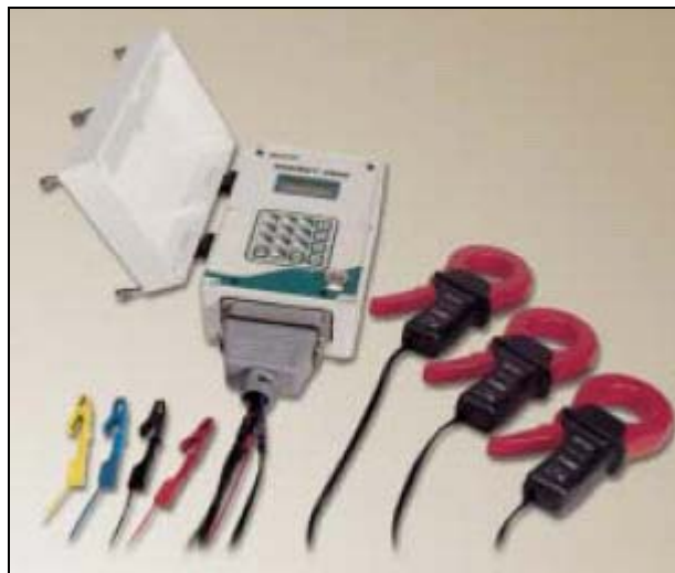
Figura 2.5 - Exemplo de instrumento analisador de qualidade de energia. FONTE: RMS Sistemas Eletrônicos
