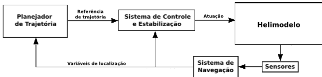
Figura 2.1: Arquitetura geral de um robô helicóptero.
