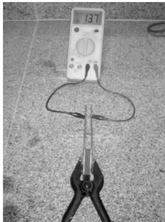
Figura 1 – Capacitor construído para coleta da capacitância. Figure 1 – Capacitor built for capacitance collection.
