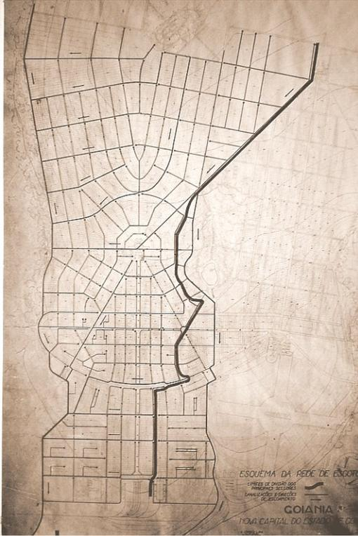
**Figuras 85** – Esquema do sistema de esgoto para Goiânia.
