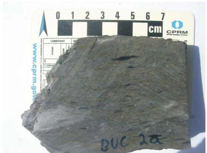
4.12. Amostra de mão de álcali-basalto de coloração acinzentada, maciça com fraturas que em microscopia observa-se que estão preenchidas por carbonato. Fenocristal elipsoidal de plagioclásio também é notório.
