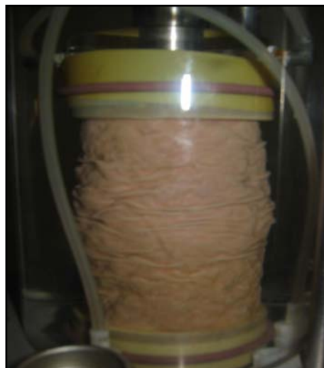
Figura 5.18 - Corpo de prova ao final do ensaio.
