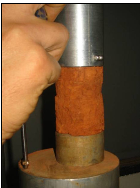
Figura 4.15 - Ensaio de resistência à compressão.
