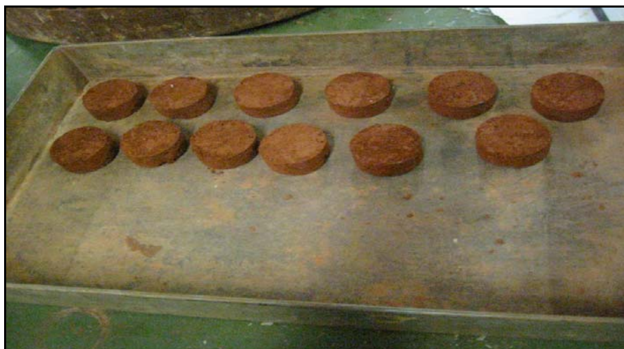
Figura 4.10 - Corpos de prova retirados de bloco inderformado para o ensaio de curva característica.
