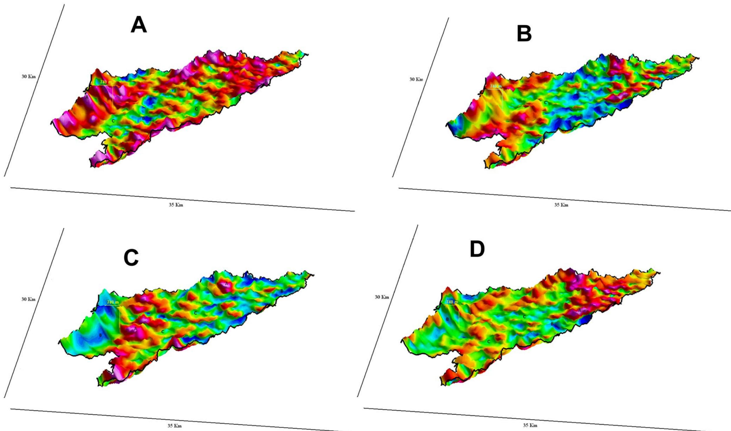
Figura 5.1.6 Superposição da imagem radiométrica do Th (A); do K (B); do U (C) e da CT (D) com o MDT. As letras A (alto), B (baixo) e C (médio) nas imagens, estão relacionadas às respectivas concentrações do radioelementos.
