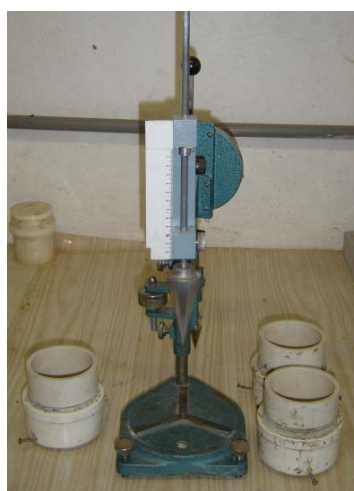
Figura 4.3 – Detalhes do equipamento para o ensaio de penetração do cone
