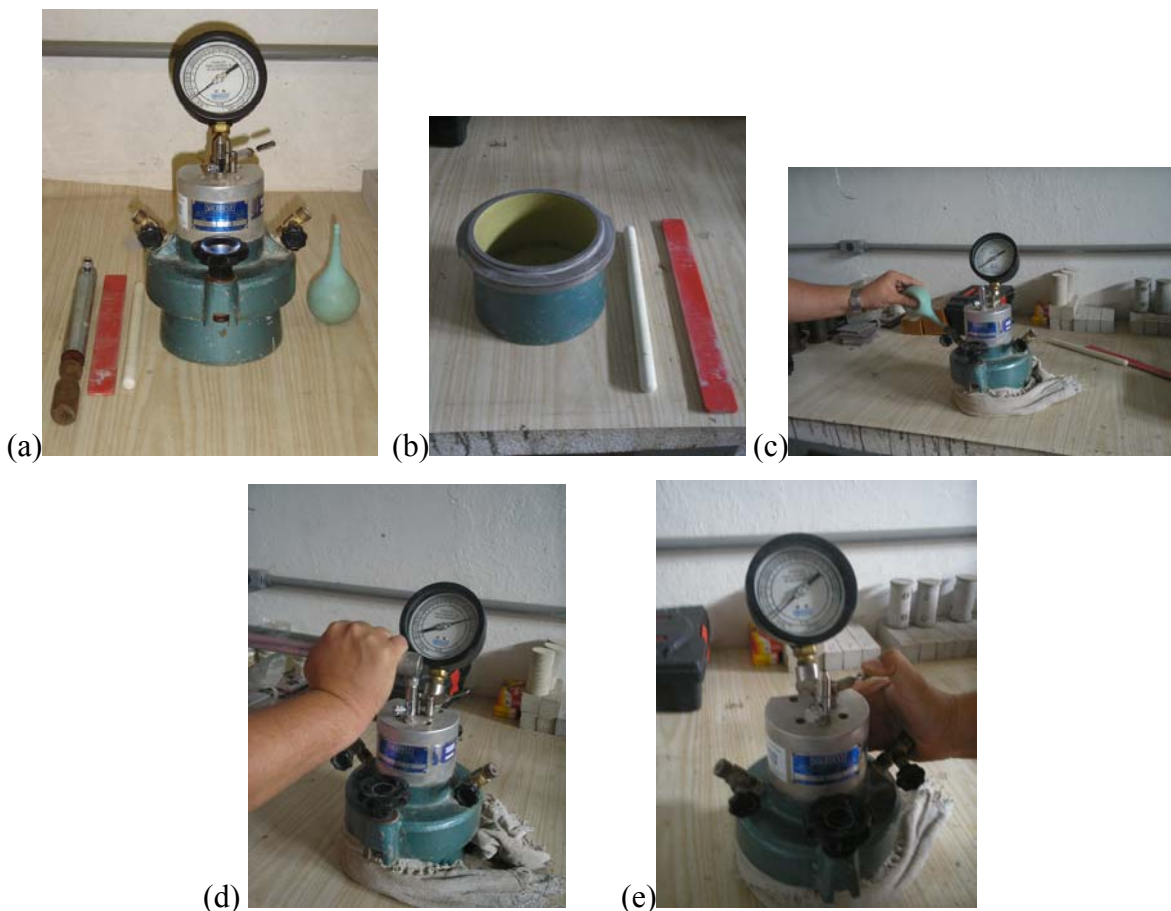
Figura 4.2 – (a) Aparelho SOLOTEST, (b) Recipiente base, (c) Injeção de água, (d) Obtenção da pressão do ensaio e (e) Leitura do teor de ar incorporado
