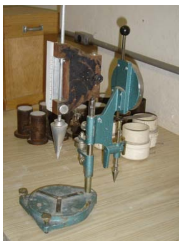
Figura 4.3 – Detalhes do equipamento para o ensaio de penetração do cone
