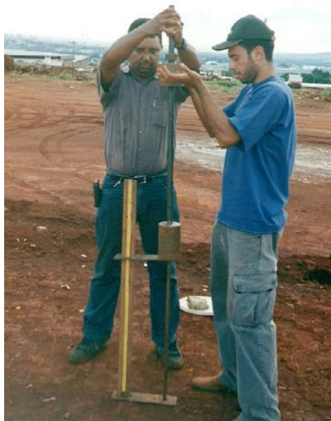
Figura 3.13 - Execução do ensaio com o penetrômetro dinâmico de cone (DCP).
