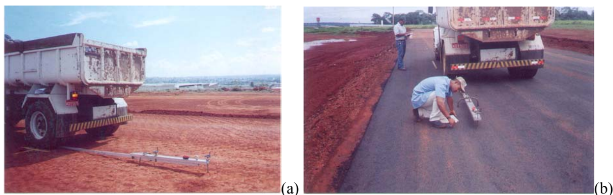
Figura 3.11 – Medidas de deflexões com a viga Benkelman: (a) sobre o subleito; (b) sobre o revestimento
