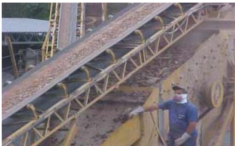
Figura 2.10 - Detalhe do britador da prefeitura municipal de Goiânia: correia transportadora com os resíduos sólidos britados e sistema de peneiras (Silva, 2004).
