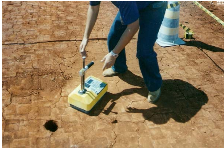
Figura 3.16 - Determinação do peso específico de campo utilizando o densímetro nuclear.
