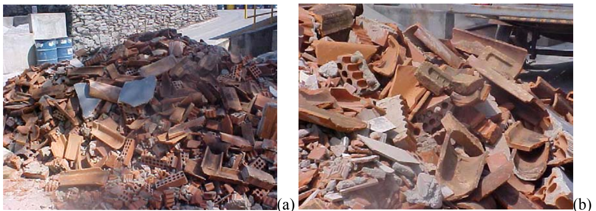
Figura 3.2 - Resíduos sólidos cerâmicos antes da britagem: (a) vista geral da pilha; (b) detalhe dos elementos constituintes da amostra.
