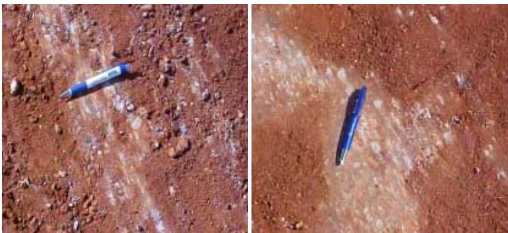
Figura 2.11 - Vista superior das camadas da pista experimental de Goiânia após a compactação: (a) sub-base; (b) base (Silva, 2004).
