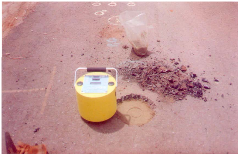
Figura 3.15 - Geogauge: detalhe do equipamento e ensaio sobre a base de agregados reciclados.
