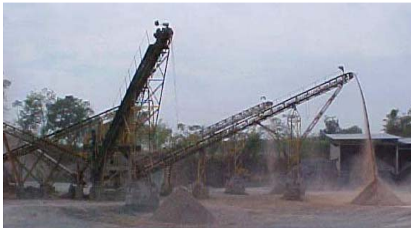
Figura 2.9 - Produção de agregados reciclados no britador da prefeitura municipal de Goiânia (Silva, 2004).
