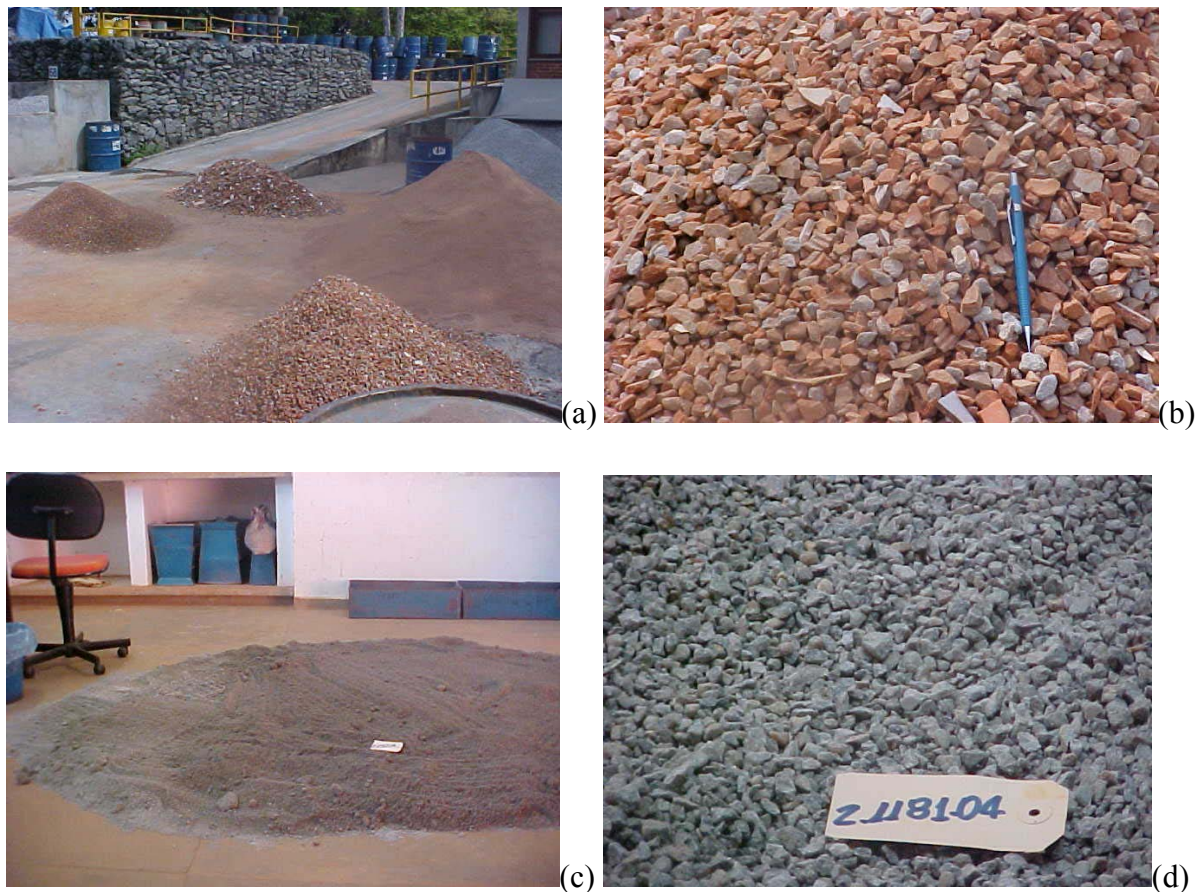
Figura 3.4 - Agregados reciclados obtidos da britagem de resíduos sólidos: (a) pilhas de ARM; (b) detalhe do ARM 19,1; (c) secagem do ARC 4,8; (d) detalhe do ARC 19,1.
