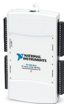
Figura 3. 4 – Placa de aquisição de dados. Fonte: National Instruments.
