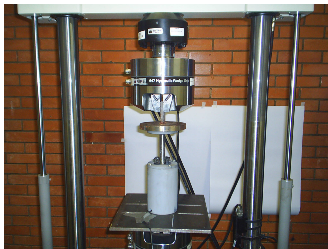
Figura 6.3. Montagem do Protótipo 1.0 na máquina de ensaios universal MTS 810.
