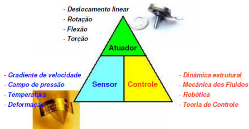
Figura 2.1. Diagrama esquemático de uma estrutura adaptativa.
