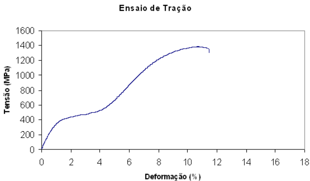
Figura 3.12. Curva Tensão-Deformação – Fio2.
