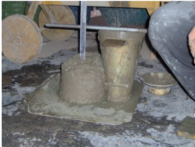
Figura 3.26 – Ensaio de abatimento de tronco de cone
