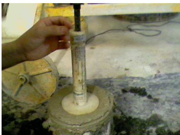
Figura 3.28 – Ensaio flow gauge. Penetrômetro graduado.
