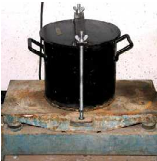
Figura 3.29 – Mesa vibratória e recipiente utilizados no ensaio de exsudação.
