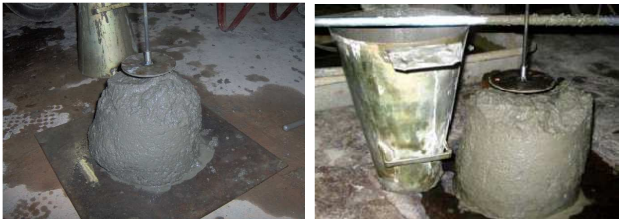
Figura 3.27 – Ensaio de tronco de cone modificado
