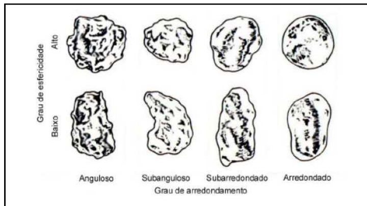
Figura 2.10 – Carta de avaliação visual dos graus de esfericidade e arredondamento constante na NBR 7389 (1992)
