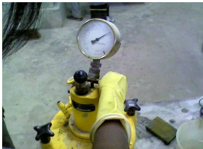
Figura 3.30 – Determinação do teor de ar incorporado pelo concreto
