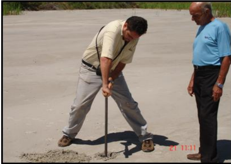
Figura 3.4. Coleta de amostra do rejeito, realizado dentro da Barragem.
