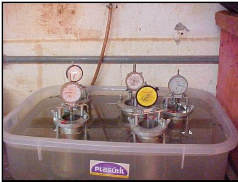
Figura 3.8. Ensaio de MINI-CBR conforme ME 254 (DNER, 1997).
