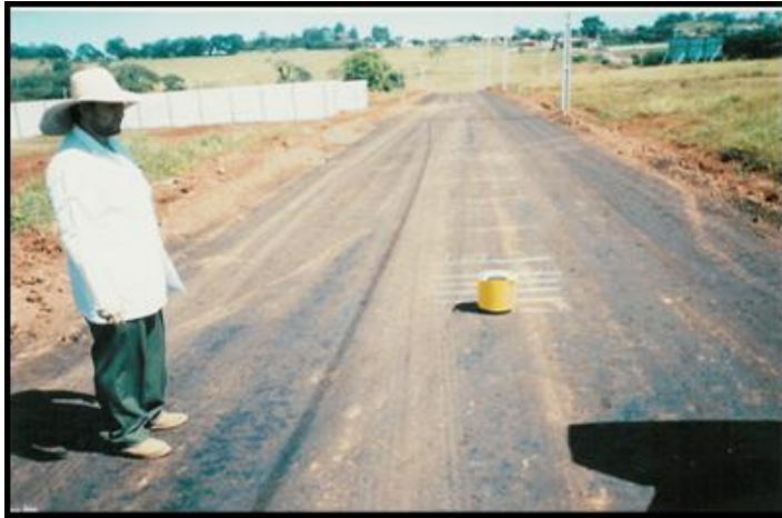
Figura 3.19. Determinação dos parâmetros de Rigidez e do Módulo de Elasticidade, com o uso do Geogauge.
