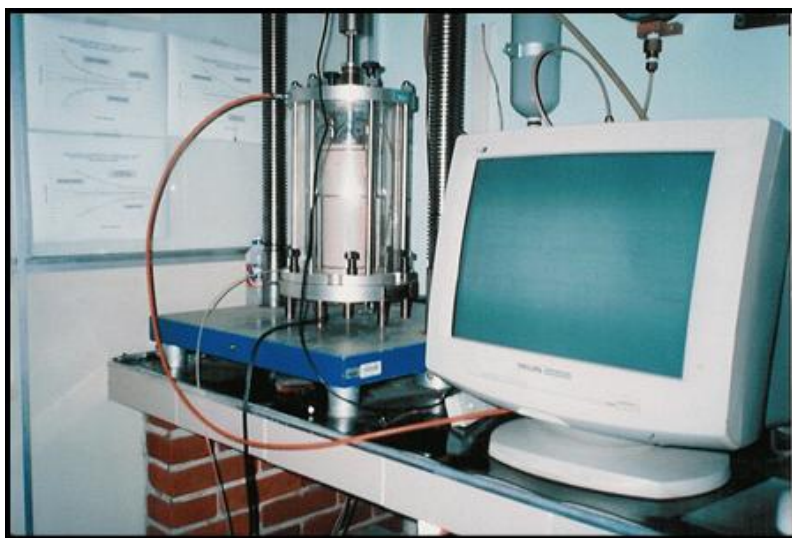
Figura 3.12. Ensaio de Módulo de Resiliência realizado na Escola Politécnica.
