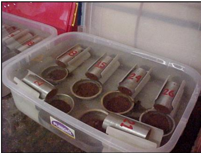
Figura 3.7. Ensaio de Perda de Massa por Imersão ME 256 (DNER, 1994).
