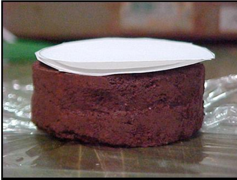
Figura 3.11. Ensaio de Sucção Metodologia do Papel Filtro ASTM- D 5298-92.
