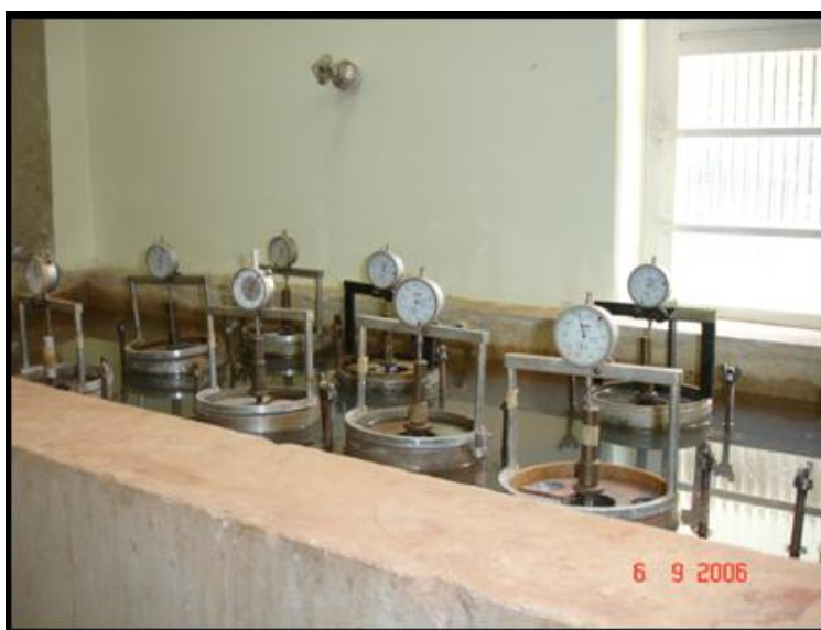
Figura 3.9. Ensaio de CBR conforme a NBR 9895(ABNT, 1987).
