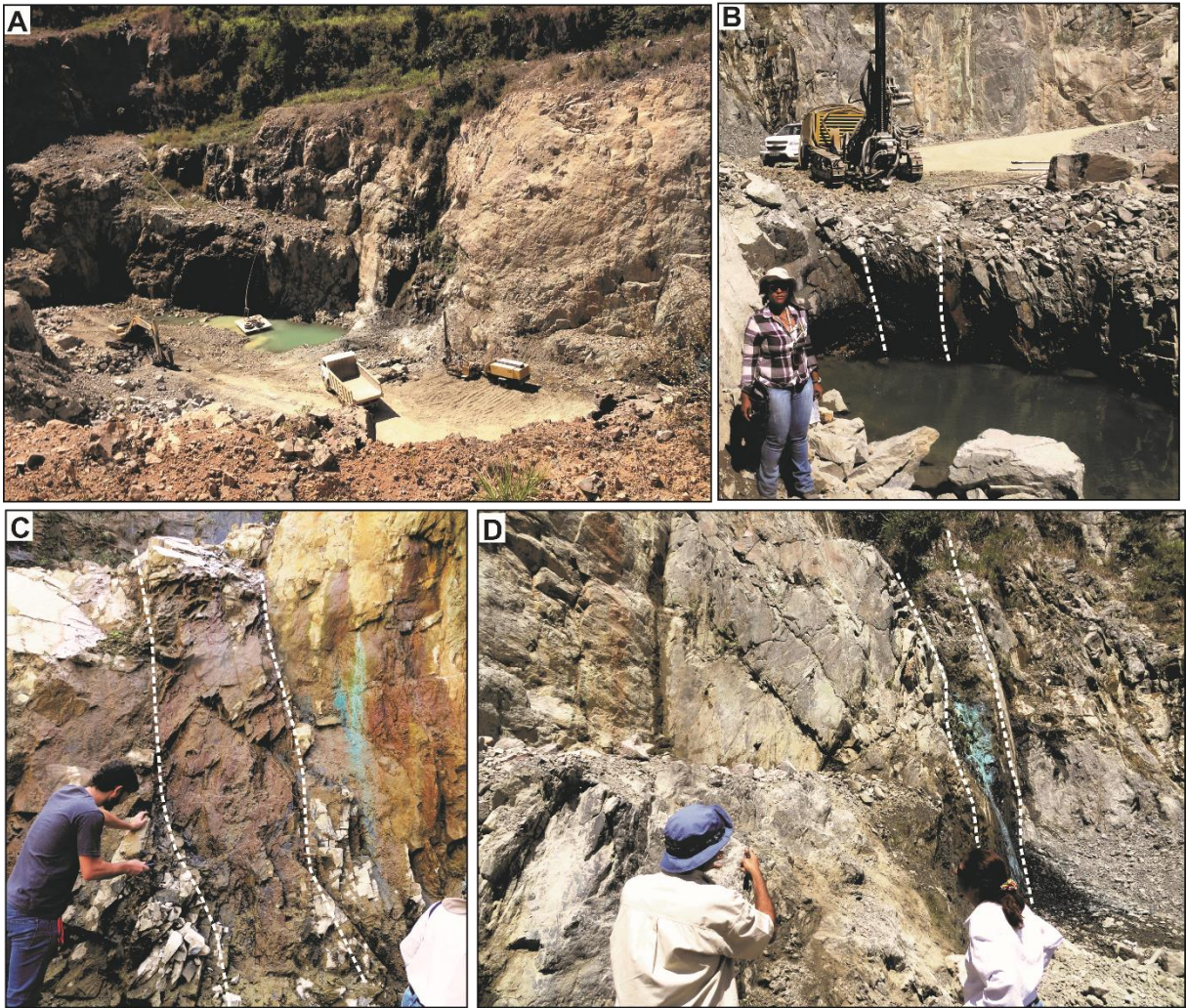
Fig. 3. A. Foto da cava garimpeira do depósito Santa Helena. B-D. Fotos mostrando a zona mineralizada principal (tracejado branco).
