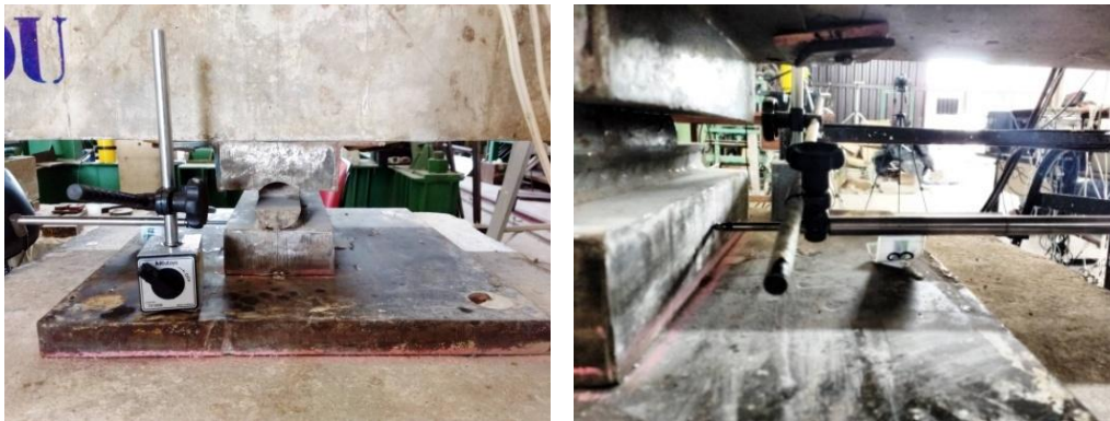
Figura 3.49 – Detalhes do LVDT utilizado para medir o deslocamento horizontal da cabeça inferior do pilar
