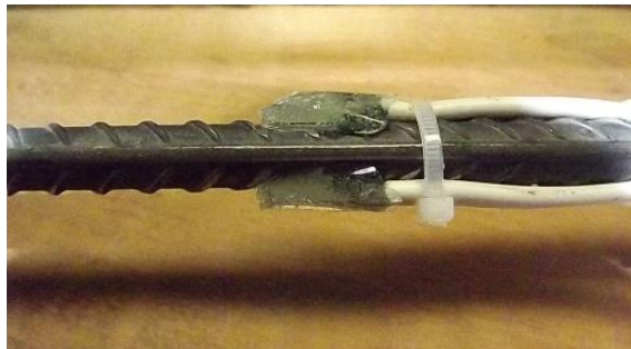
Figura 3.35 – Proteção e isolamento com adesivo epóxi
