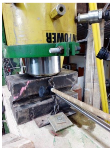
Figura 3.50 – Detalhe LVDT utilizado para medir o deslocamento horizontal da cabeça superior do pilar.
