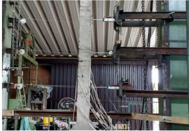
Figura 3.48 – Sistema de roldanas para a garantia de contato haste/pilar
