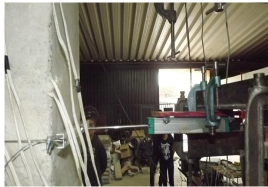
Figura 3.47 – Detalhe Potenciômetro usado para medir deslocamento horizontal central
