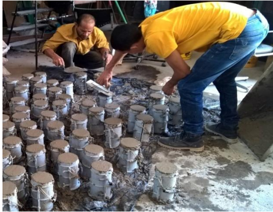
Figura 3.11 – Moldagem dos corpos de prova
