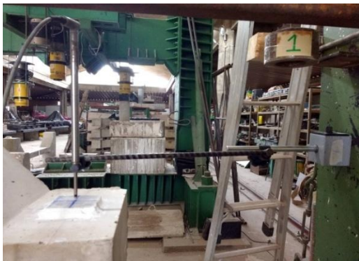
Figura 3.46 – Detalhe LVDT usado para medir deslocamento vertical
