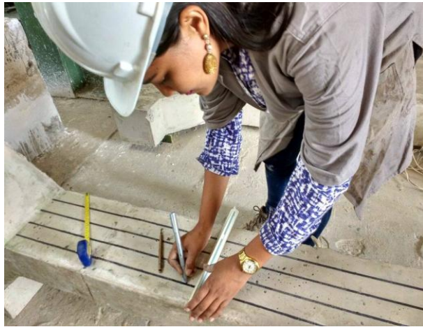
Figura 3.20 – Execução de linhas de marcação para corte da seção
