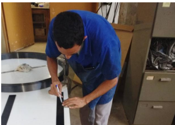
Figura 3.17 – Execução das linhas de marcação
