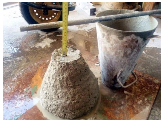
Figura 3.10 – Teste de abatimento do concreto ( Slump Test )
