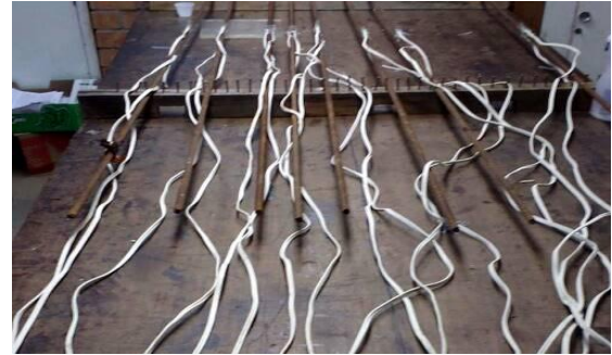
Figura 3.34 – Fios soldados nos terminais dos extensômetros
