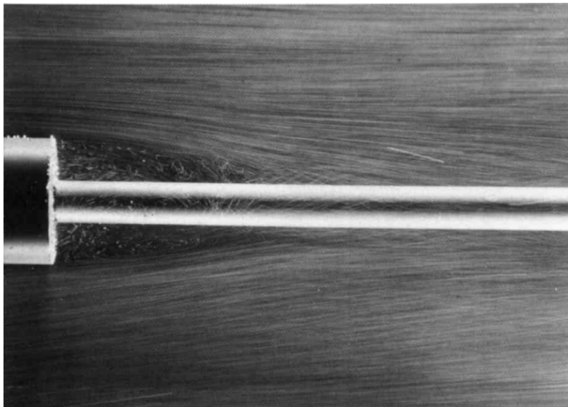
Figura 1.5: Ilustração do descolamento de camada limite provocado pela geometria, e neste caso pelo alto número de Reynolds ( Re_L \approx 10000 ), em um escoamento axisimétrico [54].
