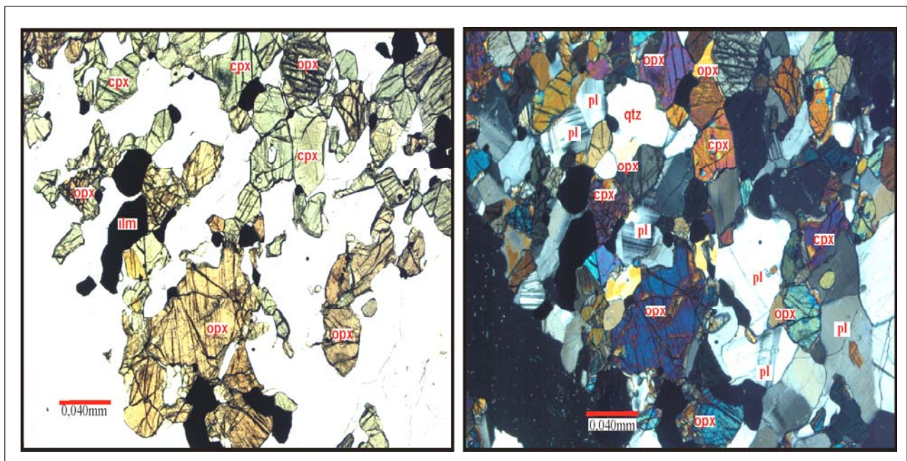
Figura 71 – Fotomicrografias de granulitos enderbíticos do domínio estrutural II com paragênese de Opx+Cpx+Ilm e ausência de hornblenda (foto da esquerda nicóis paralelos e a direita nicóis cruzados).
