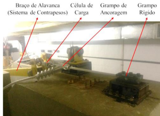
Figura 3.7 – Ancoragem do cabo nos dois lados do vão.
