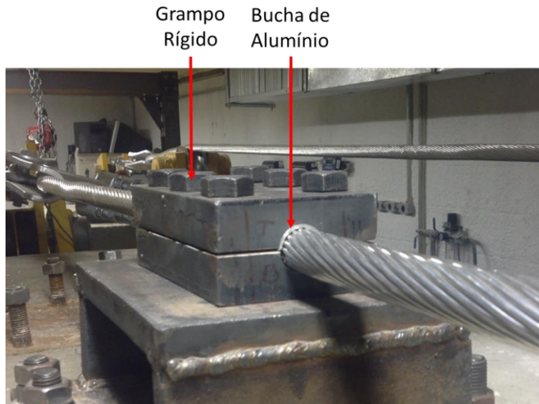
Figura 3.13 - Montagem do grampo rígido com bucha de alumínio.
