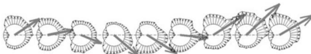
Figura 2.3 – Distribuição de pressão e modulo da força em nove momentos do desprendimento de vórtices (Zasso, et al., 1988).
