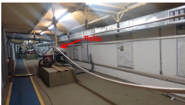
Figura 3.11 – Condutor apoiado em polias ao longo do vão.
