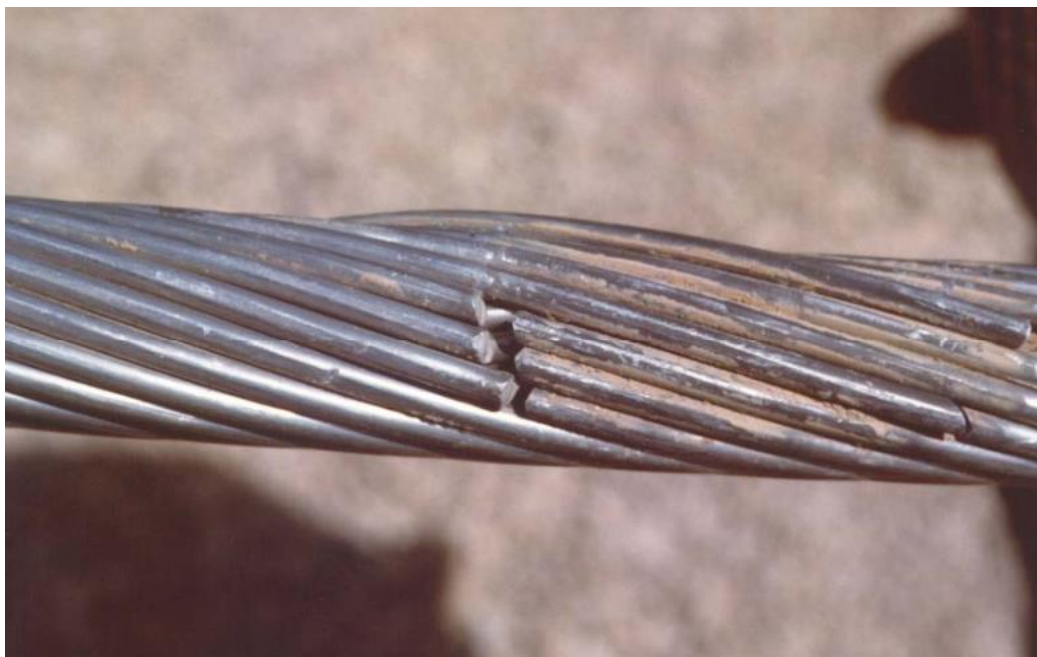
Figura 2.1 – Fios rompidos devido falha por fadiga (Cosmai, 2009).
