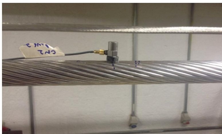
Figura 3.14 – Acelerômetro que realiza o controle do ensaio.
