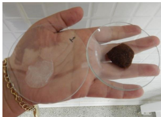
Figura 35 – Hidrogéis intumescidos: a esquerda o hidrogel purificado e a direita o hidrogel do Envoltório in natura
