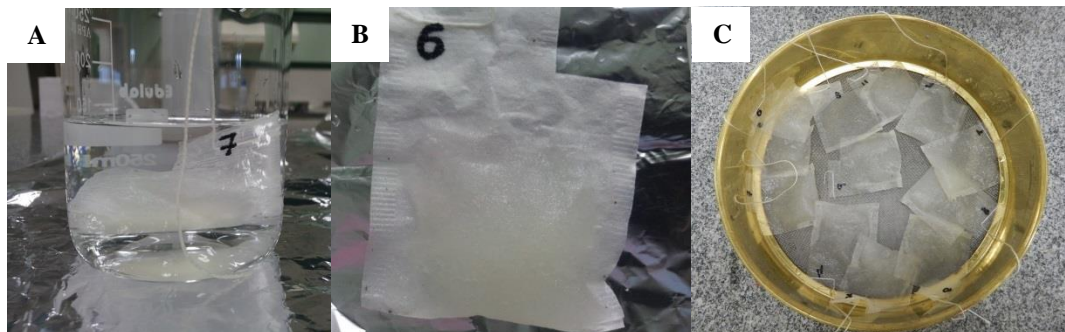
Figura 34 – Processo de intumescimento dos hidrogéis através do método do saquinho de chá
