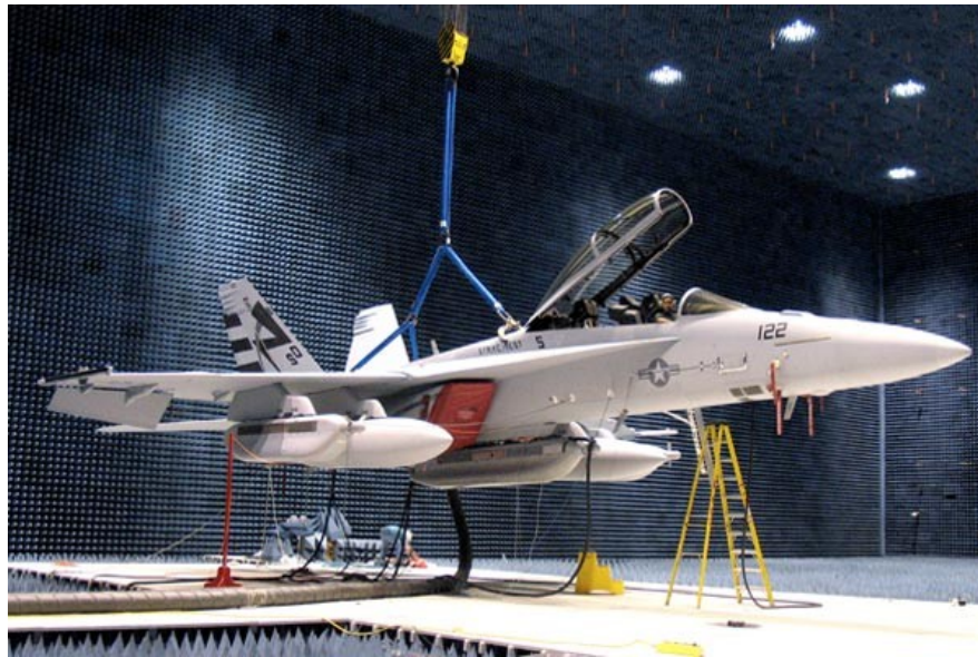
Figura 2.4-Câmara Anecóica de grande porte. Avaliação de CEM em aeronaves (Laboratórios Boeing)
