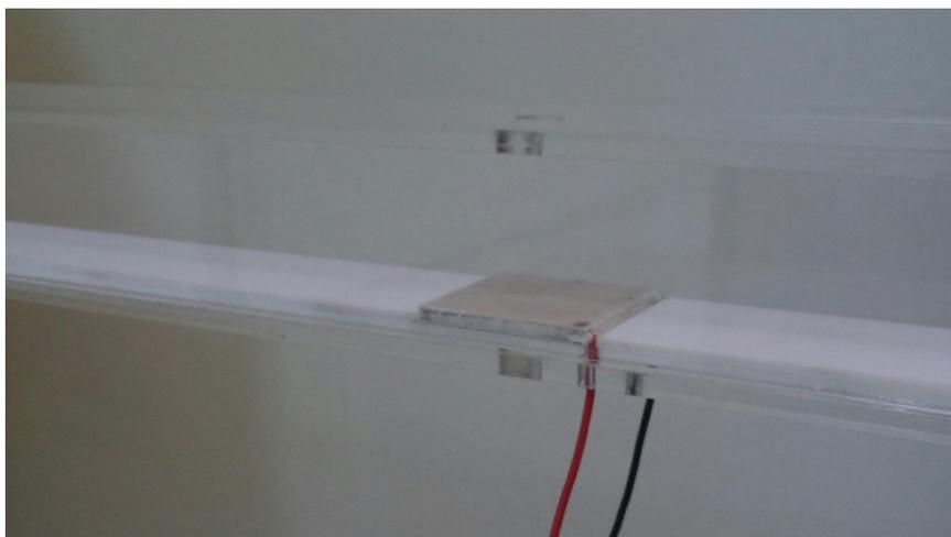
Figura 4.13: Detalhe do encaixe da célula Peltier no canal
