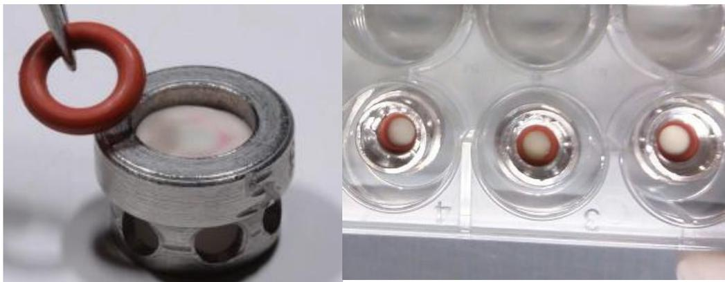
**Figura 4.** Esquerda: Demonstração de um dispositivo de Câmara Pulpar Artificial, com disco de dentina posicionado, previamente à colocação do anel de silicone para vedação lateral. Direita: CPAs posicionadas invertidas em placa de 24 poços.
