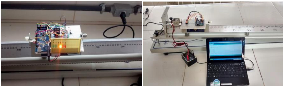
4- DAMAC SENDO TESTADO NO LABORATÓRIO
