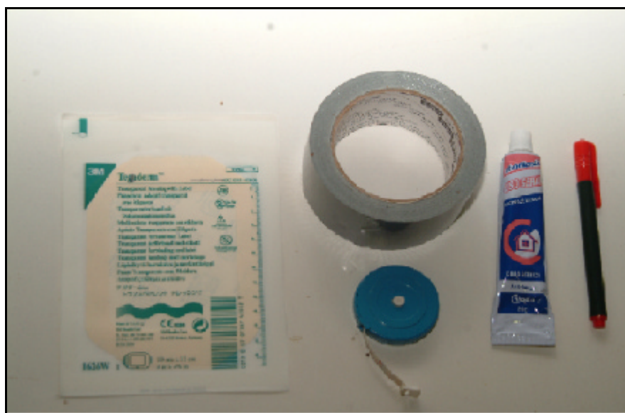
Figura 5.2 - Fitas adesivas para proteção dos eletrodos contra água e trena para as medições antropométricas.
