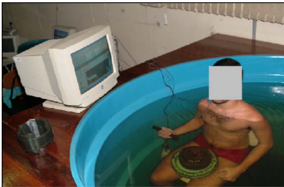
Figura 5.8 - Arranjo físico do posto de trabalho tanque grande. A cadeira é a mesma que foi utilizada para a experimentação em ambiente aéreo. No canto inferior esquerdo da fotografia, nota-se a pulseira utilizada para compensar o efeito do empuxo da água em um dos dois postos de trabalho no tanque pequeno e em um posto do tanque grande.
