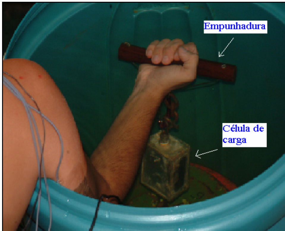
Figura 5.7 - Detalhe do posto de trabalho tanque grande. A célula de carga foi fixada no fundo do tanque.
