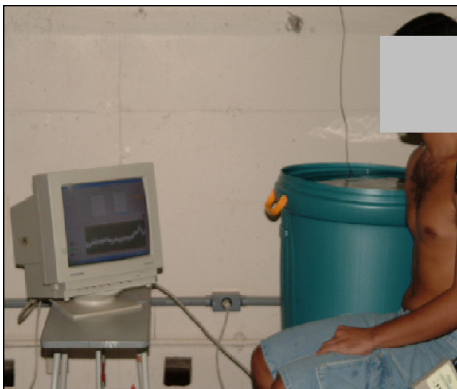
Figura 5.6 - Arranjo físico geral do posto de trabalho tanque pequeno. O sujeito submerge em água somente a mão, o antebraço e o braço até a altura da axila.
