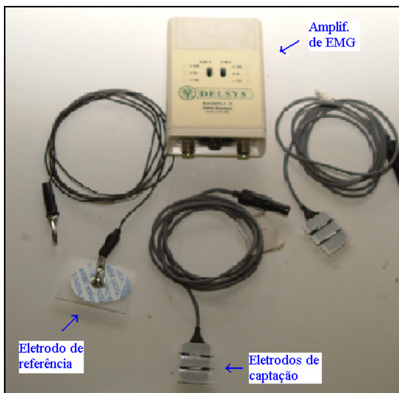
Figura 5.1 - Eletrodos de captação e de referência e amplificador de EMG.
