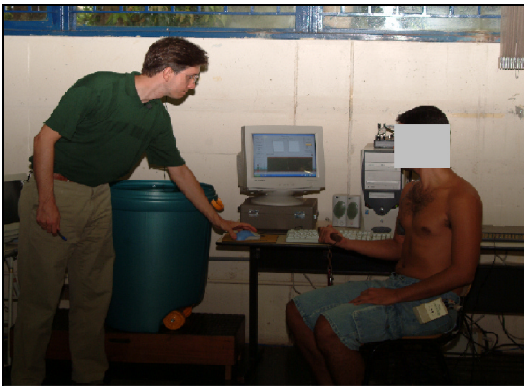
Figura 5.5 - Arranjo físico do posto de trabalho em ambiente aéreo. O sujeito flexiona o cotovelo direito, puxando verticalmente para cima a empunhadura, e vê o valor instantâneo de sua força no monitor de vídeo (retroalimentação visual).
