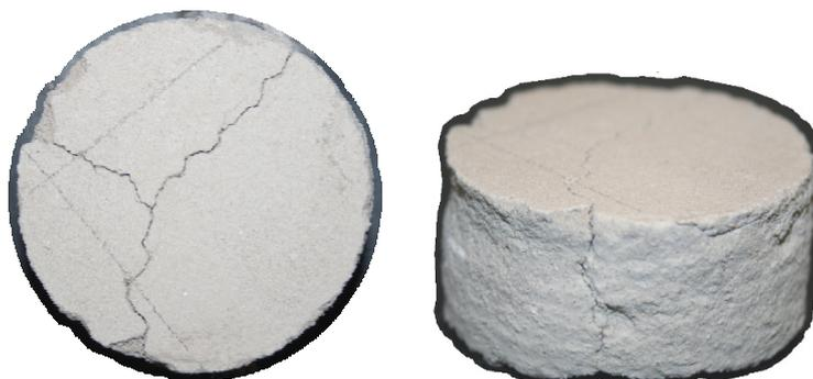
Figura 4.48 – Amostra extraída da região do revestimento com fissuras do corpo-de-prova SC.AME6.30\_Sev.
