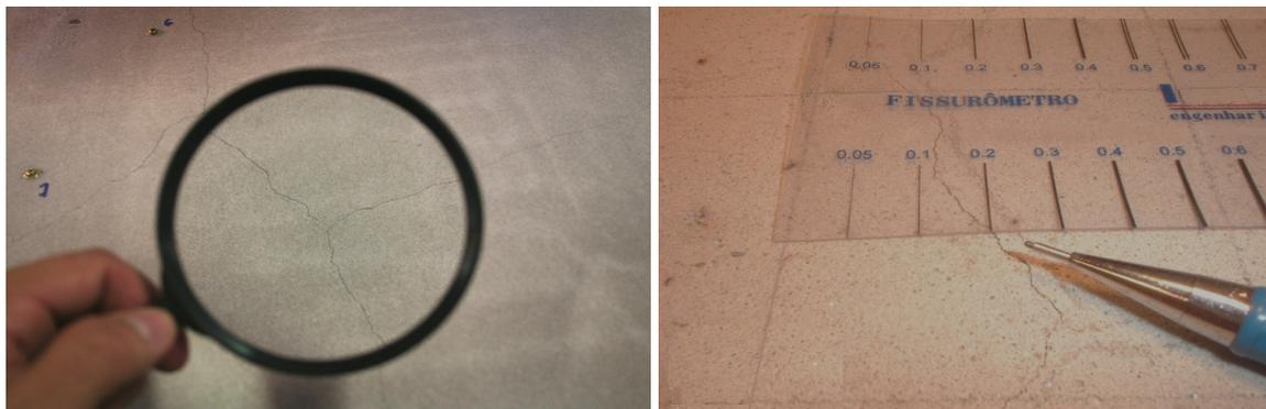
Figura 3.34 – Lupa e fissurômetro utilizados no levantamento das fissuras do revestimento.
