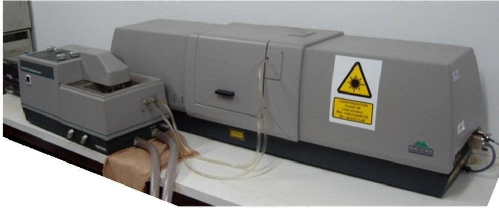
Figura 3.12 – Granulômetro a laser do Laboratório de Geotecnia da UnB.
