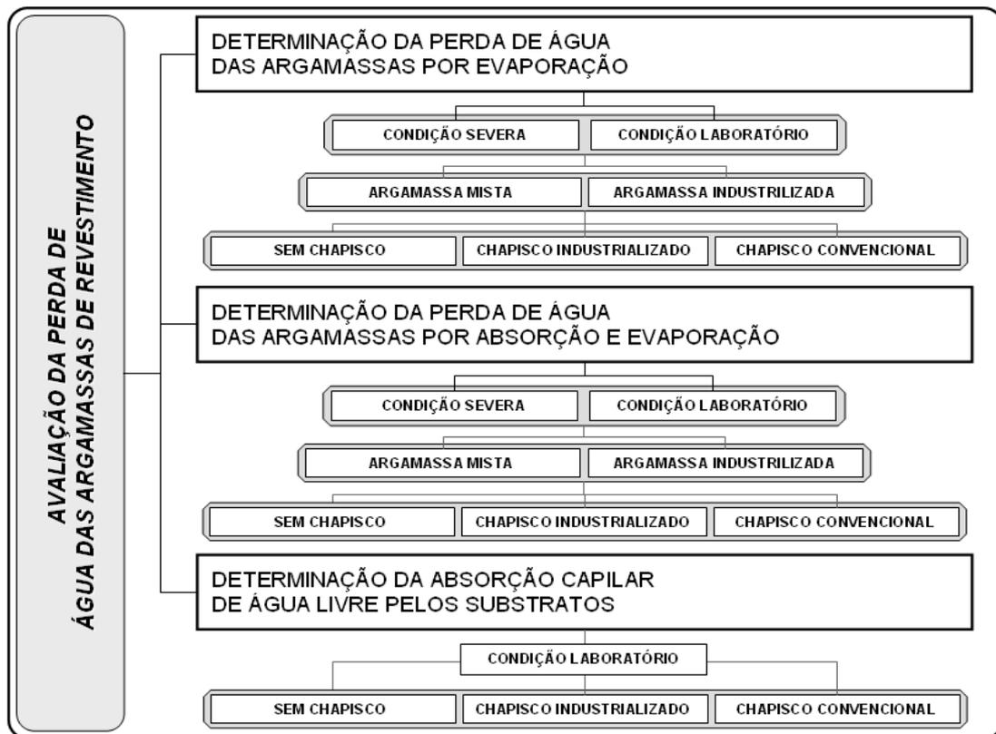
Figura 3.38 – Fluxograma dos ensaios para avaliação da perda de água das argamassas de revestimento.
