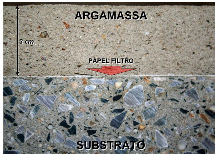
Figura 3.5 – Seção do corte do corpo-de-prova com papel filtro usado para o ensaio de retração do revestimento.
