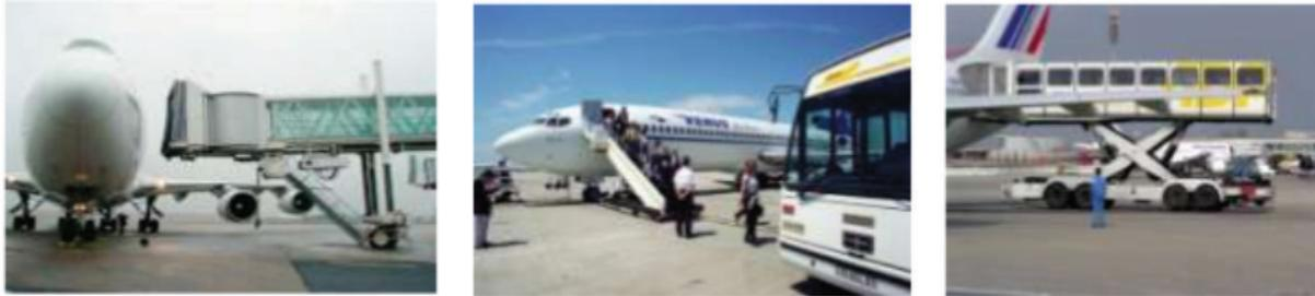
Figura 4.4: Diferentes dispositivos para lidar com os passageiros nos processos de embarque e desembarque [41].
