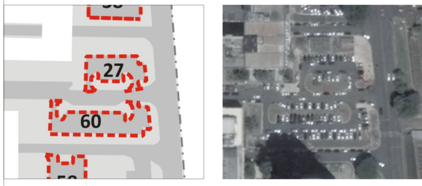
Figura 6.12 Detalhe para a contagem de carros por imagem aérea (imagem aérea de 28 de março de 2016).
