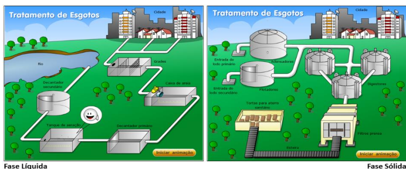
Figura III. Fases do Tratamento de Esgotos.
