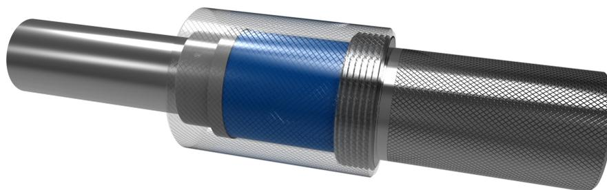
Figura 13 – **Montagem do conjunto amortecedor.** Figura demonstrativa da montagem do conjunto, (autoria própria).
