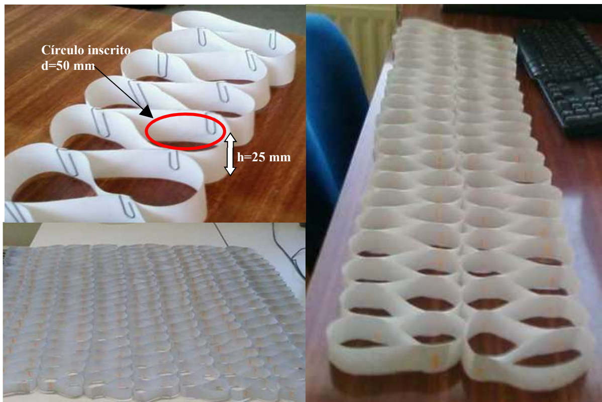
Figura 4.4: Confeção dos alvéolos.
