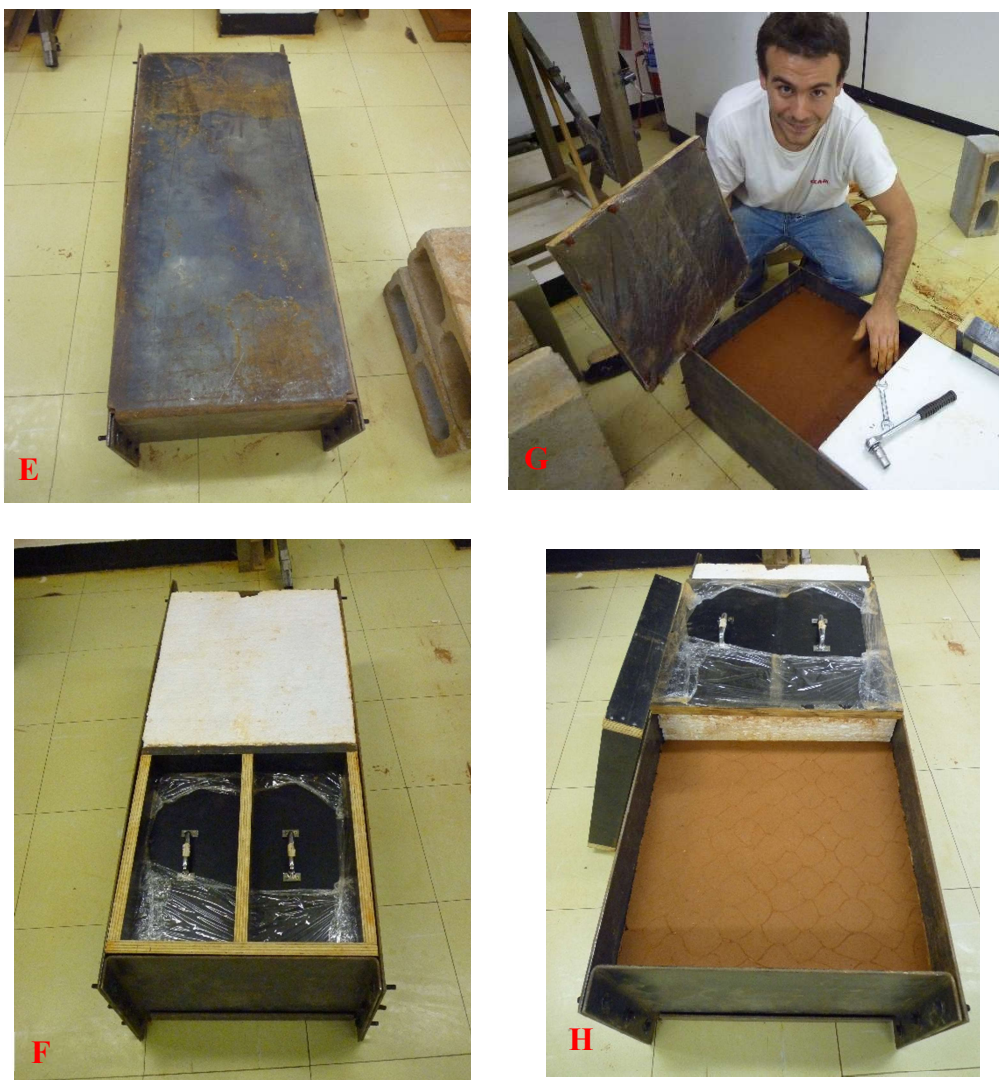
Figura 2.35: Procedimento de compactação efetuado por Chapelet (2010). Onde: E) Inversão da caixa metálica; F) Abertura da caixa; G) Retirada do fundo falso e H) Material pronto para ensaio.
