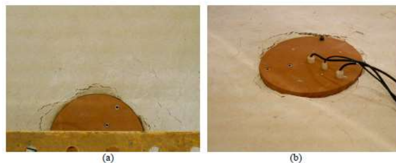
Figura 2.6: Mecanismo de ruptura obtido para camadas de areia com 0,50% de fibras: a) vista superior e b) vista lateral. (Donato, 2007).
