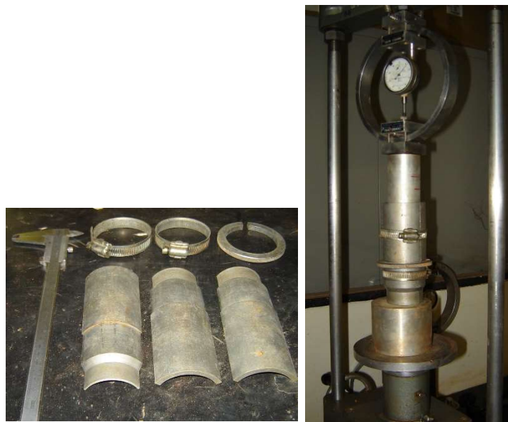
Figura 4.1: Moldes e prensa utilizados na compactação estática.
