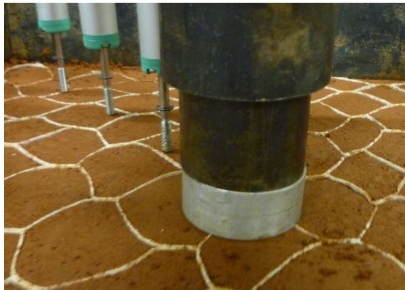
Figura 5.45: Detalhe do pistão de carregamento e alvéolos em geossintético.
