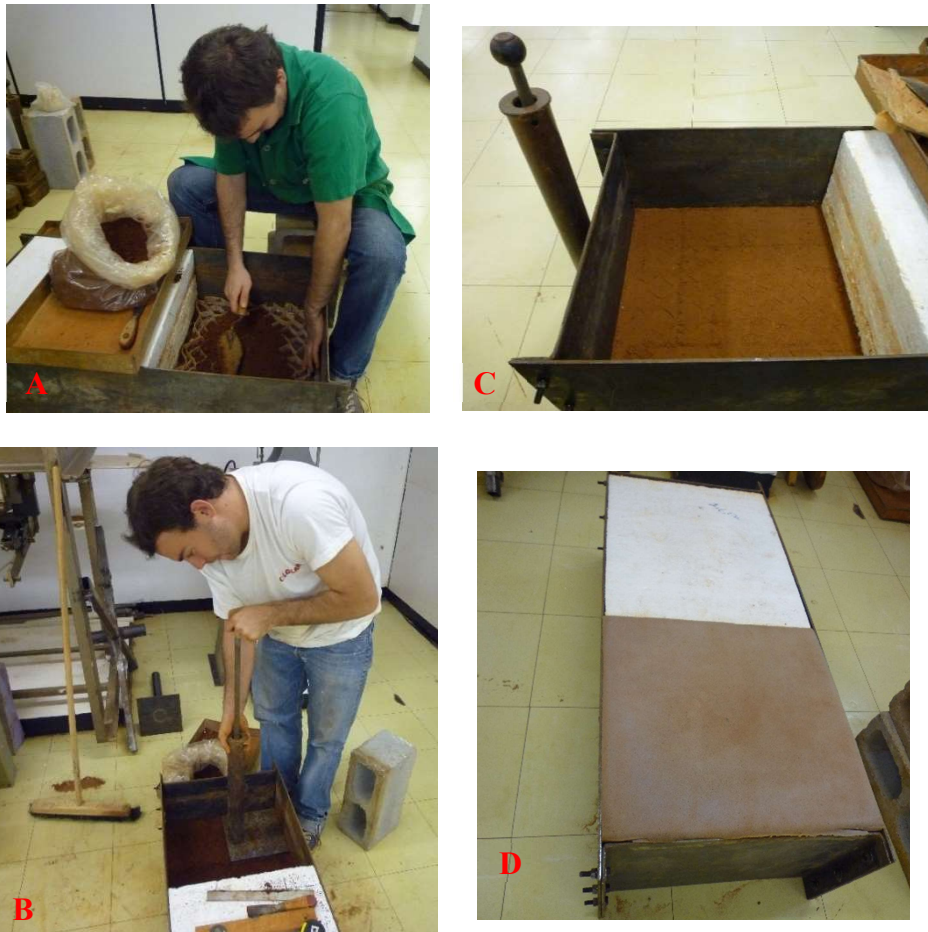
Figura 2.34: Procedimento de compactação efetuado por Chapelet (2010). Onde: A) Preenchimento dos alvéolos; B) Compactação; C) Material compactado e D) Colocação do material de base.
