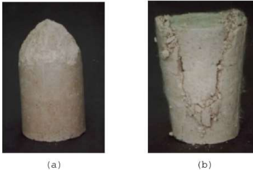
Figura 2.13: Amostras apresentando formação diferenciada dos planos de ruptura para a) argila com adição de 7% de cimento e b) argila com adição de 7% de cimento e fibra de 12mm (Feuerharmel, 2000).
