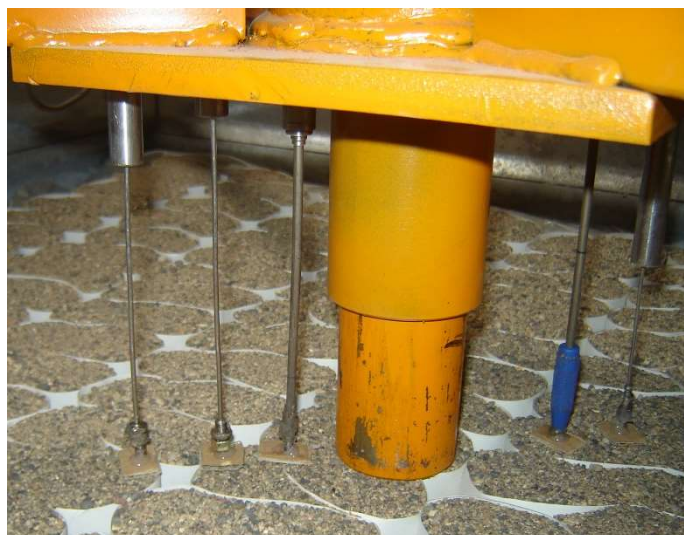
Figura 5.36: Detalhe do pistão de carregamento e alvéolos em papel.
