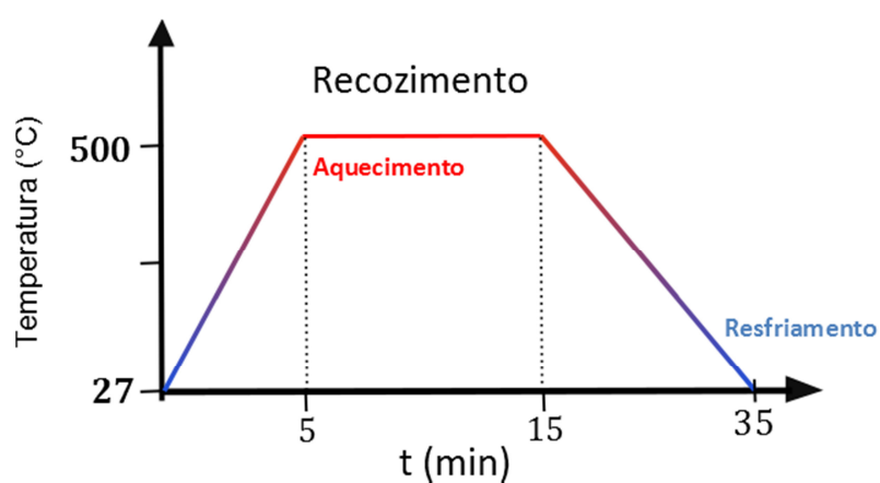
Figura 3.5. Histórico de temperatura do tratamento térmico.
