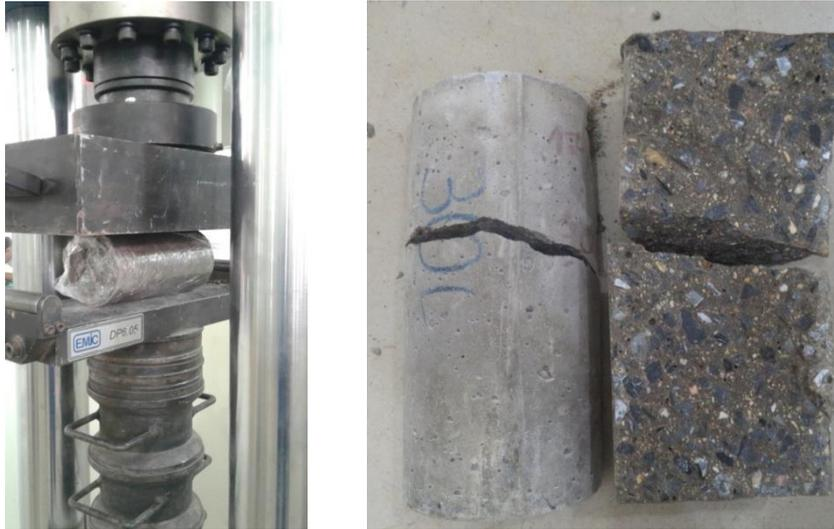
Os resultados das resistências à tração por compressão diametral em corpos de prova de CAA cilíndricos foram calculados pelo programa TESC versão 3.04 utilizando a Equação 6, e expressos através de tabelas e gráficos.
