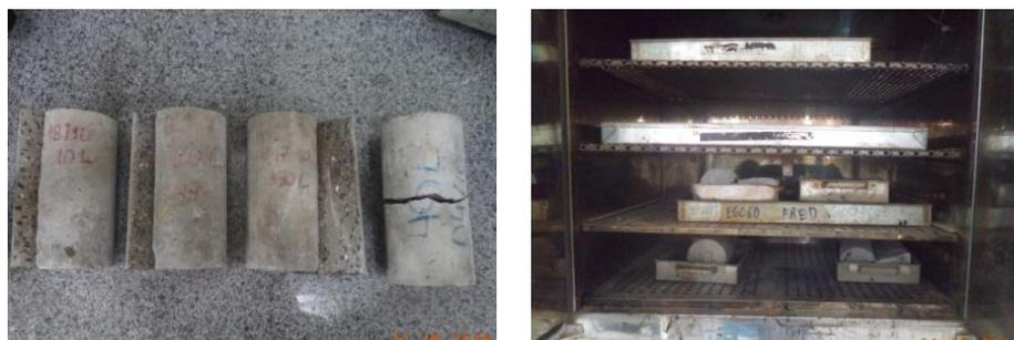
Os cálculos para determinação da absorção, índice de vazios, massa específica da amostra seca ( $\rho_s$ ), massa específica da amostra saturada ( $\rho_{\text{sat}}$ ) e massa específica real ( $\rho_r$ ) serão realizados segundo a ABNT NBR 9778 (2005) e os resultados apresentados tabelados.
