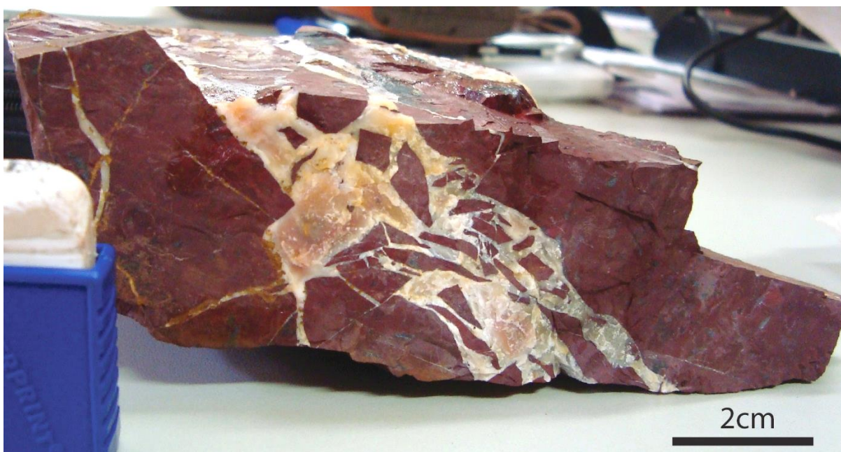
Figura 14 – Amostra de mão obtida de afloramento em região onde ocorre brechação hidráulica dentro do depósito; na matriz jaspilítica (vermelha) ocorrem pequenos cristais de hematita.
