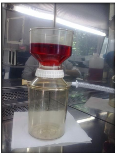
Figura 5 - Execução da filtração de 200 mL do combustível diesel S500 com o auxílio do sistema de filtração (Nalgene).
