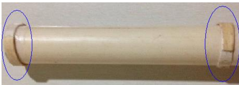
Figura 34: Anéis de 40 fixados ao tubo de 40.
