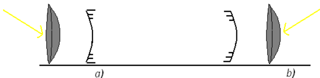
Figura 7: a) espelho côncavo e sua representação gráfica. b) espelho convexo e sua representação gráfica.
