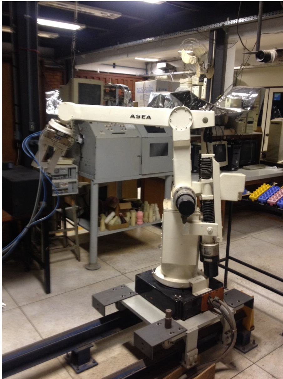
Figura 4.1: Manipulador inativo antes do retrofitting
