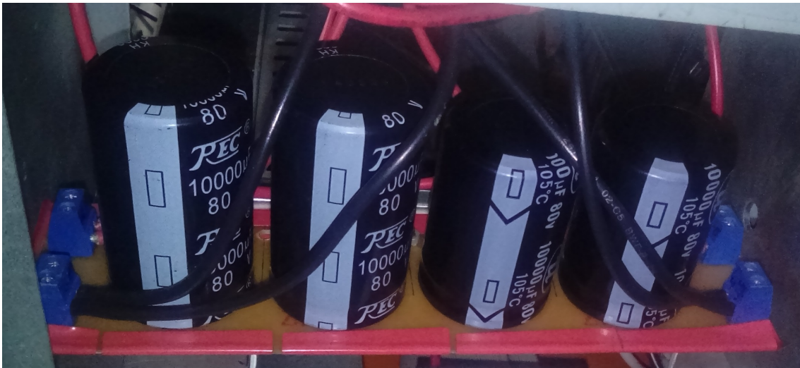
Figura 4.24: Banco de capacitores projetado para o manipulador
