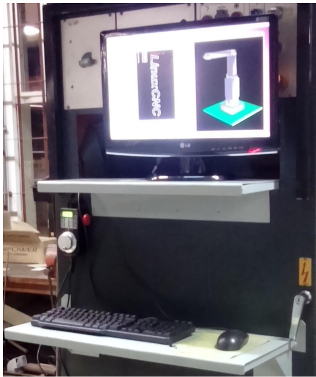
Figura 4.55: Parte frontal do gabinete de controle
