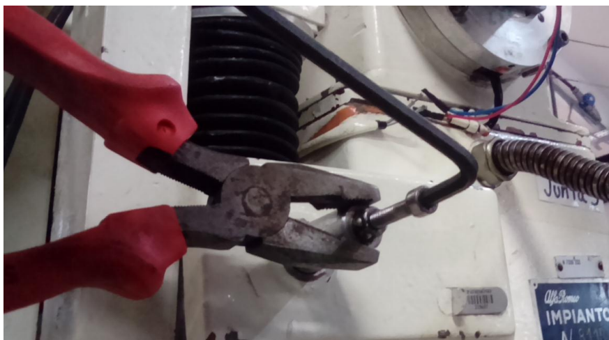
Vista da ferramenta de extração com o Alicate e chave Allen de 5 mm
