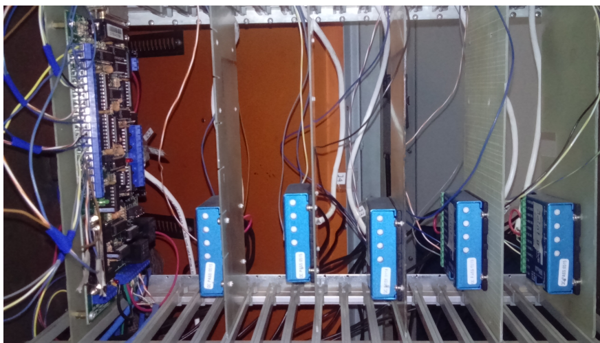
Figura 4.54: Disposição da interface paralela e os drives de controle
