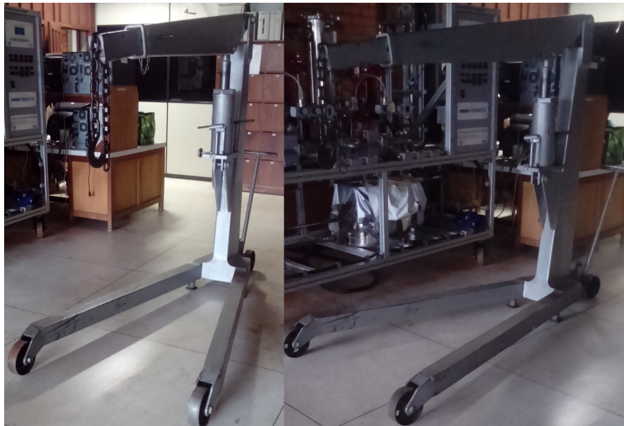
Figura 4.14: Guincho hidráulico usado para a desmontagem
