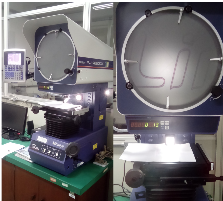
Figura 5.19: Projetor de perfil Mitutoyo PJ-A3000
