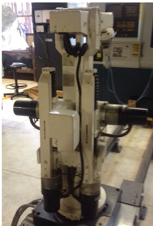
Figura 4.11: Conjunto de juntas dois e três no manipulador ASEA IRB6-S2
