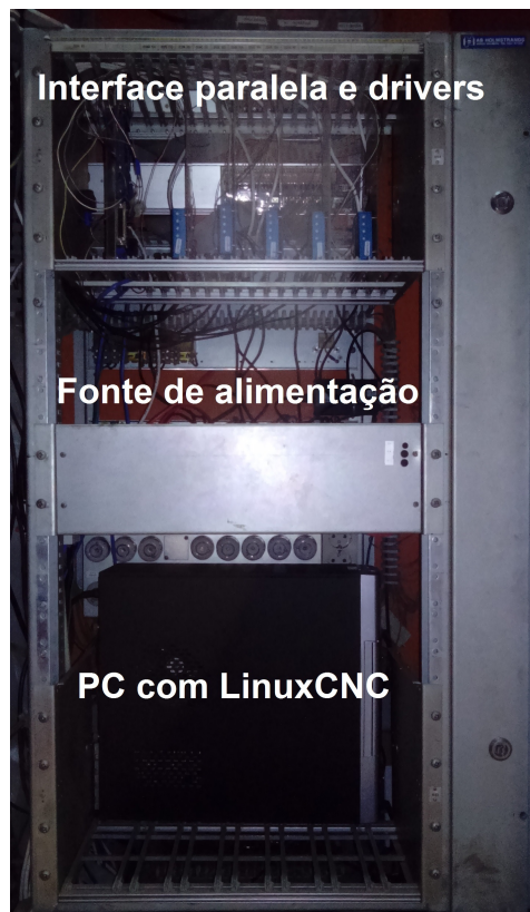
Figura 4.52: Distribuição interna do gabinete de controle
