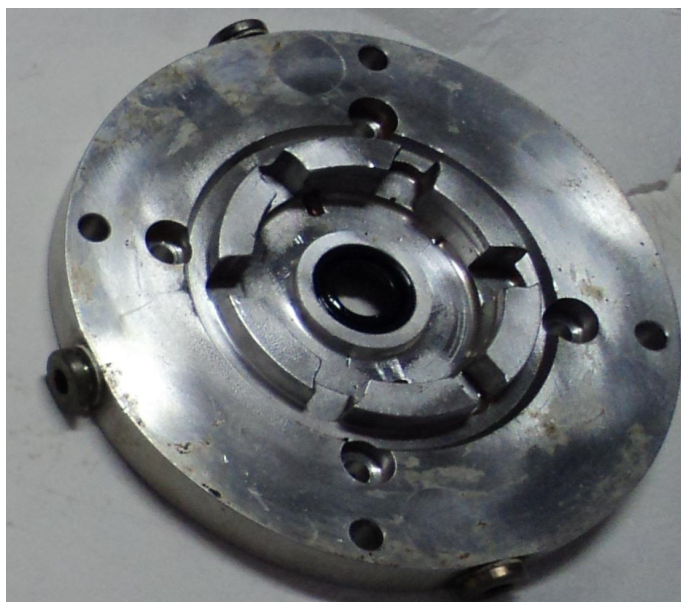
Figura 4.9: Flange das juntas quatro e cinco
