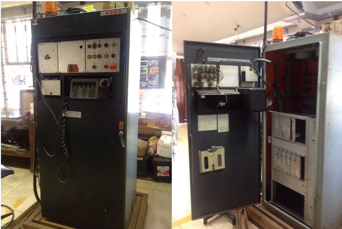
Figura 4.2: Gabinete de controle original do manipulador
