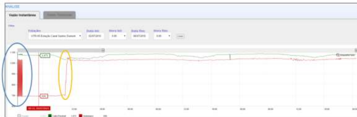
Figura C.38 – Gráfico comparativo de medições do vertedouro com a calha Parshall, em julho de 2015. Círculo azul: retirada da chapa; círculo laranja: reinstalação da chapa. (Fonte: http://ana.vector.com.br )
