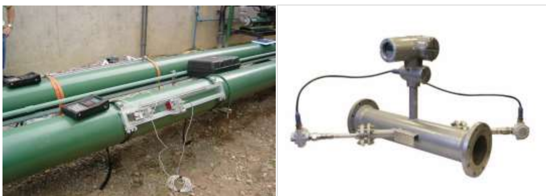
Figura 3.5 – Ultrassônico por tempo de trânsito clamp-on (esq.) e intrusivo (dir.) - Cortesia: GE Panametrics
