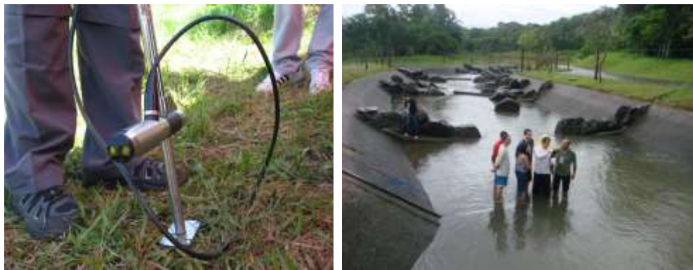
Figura 3.14 – Medição a vau com ultrassônicos tipo Doppler ( Flowtracker )
