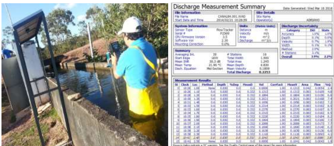
Figura C.32 – Medição de vazão no canal Santos Dumont utilizando medidor ultrassônico doppler denominado Flowtracker, em 21/02/2014 (relatório de medição à direita)
