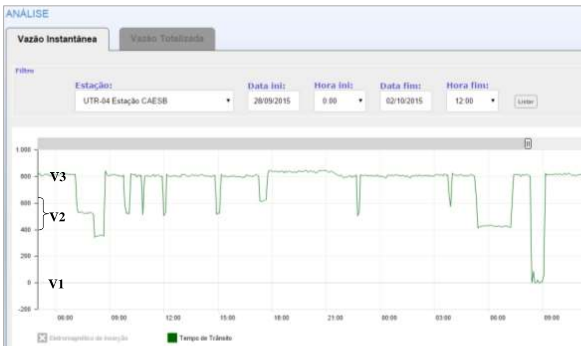
Figura C.28 – Gráfico dos dados de vazão instantânea do ultrassônico por tempo de trânsito – Estação 4 – CAESB, entre os dias 28/09 e 02/10/2015 (Fonte: http://ana.vector.com.br )
