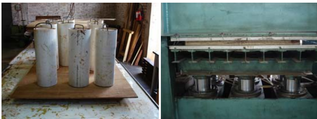
Figura 14. Etapas para a montagem do LVL: aplicação do adesivo, montagem do colchão, prensagem a frio e a quente.
