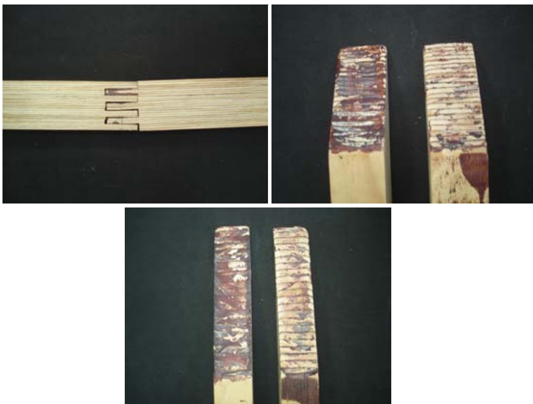
Figura 23. Ruptura das emendas macho-fêmea, bisel 1:2, e bisel 1:4.
