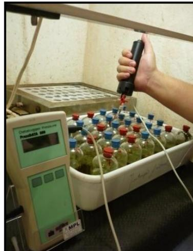
**Figura 2.3 – Aferição da pressão nos frascos de fermentação**
