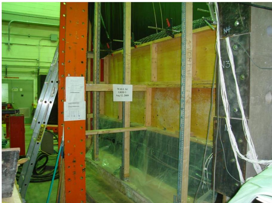
Figura 3.39. Postes de referência para a leitura dos deslocamentos da face do Muro 3.
