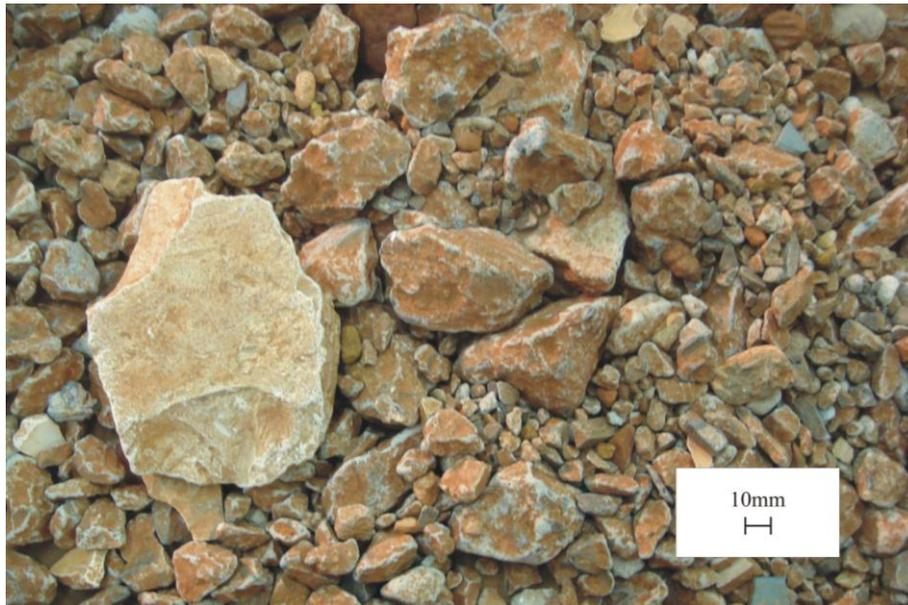
Figura 4.4. Material retido na peneira de abertura 4,8 mm (RCD-R 04)
