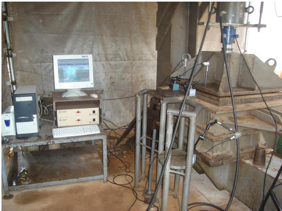
Figura 3.4. Ensaio de cisalhamento direto de grandes dimensões com RCD-R.
