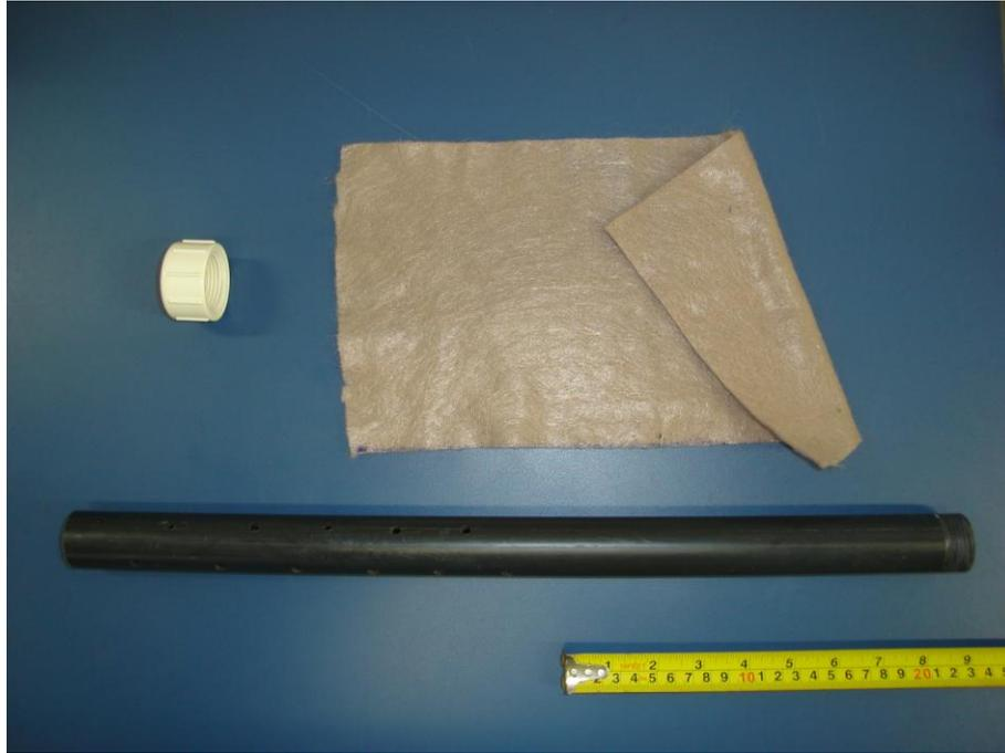
Figura 3.13. Materiais utilizados na confecção dos tubos de verificação.
