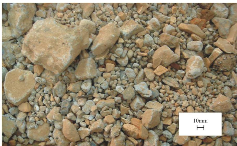
Figura 4.1. Material retido na peneira de abertura 4,8 mm (RCD-R 01)
