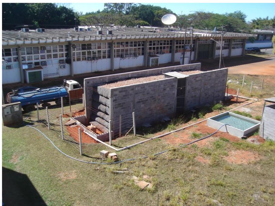
Figura 3.18. Visão geral da inundação da fundação dos muros experimentais.
