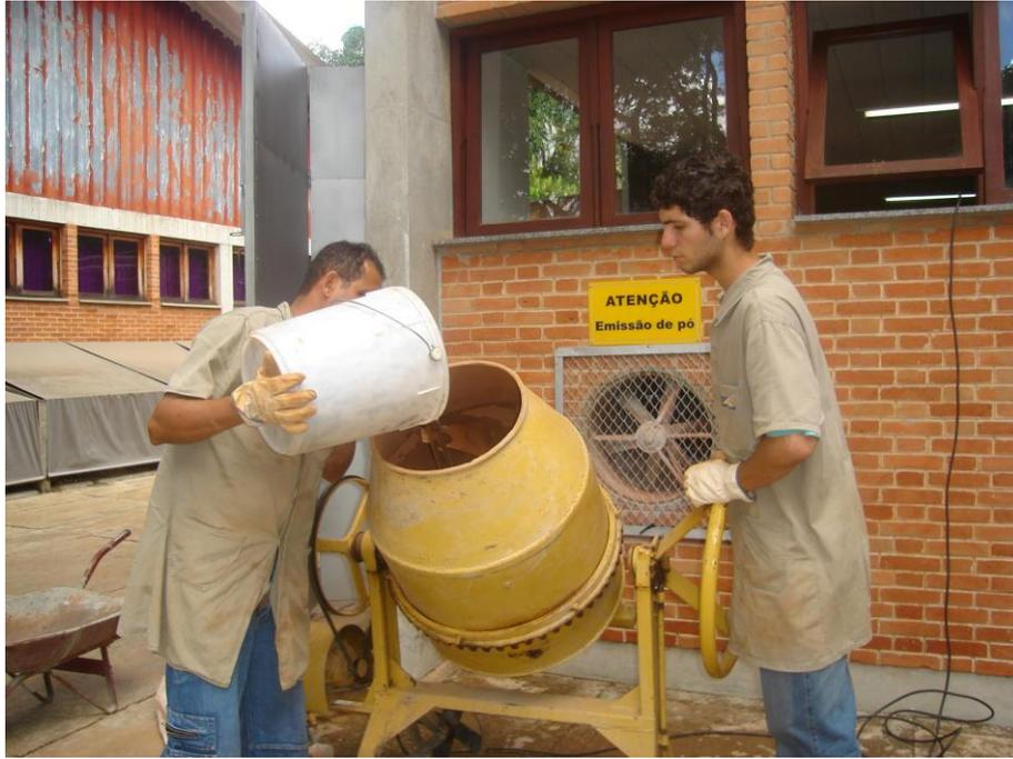
Figura 3.3. Umedecimento do RCD-R para o ensaio de cisalhamento direto.
