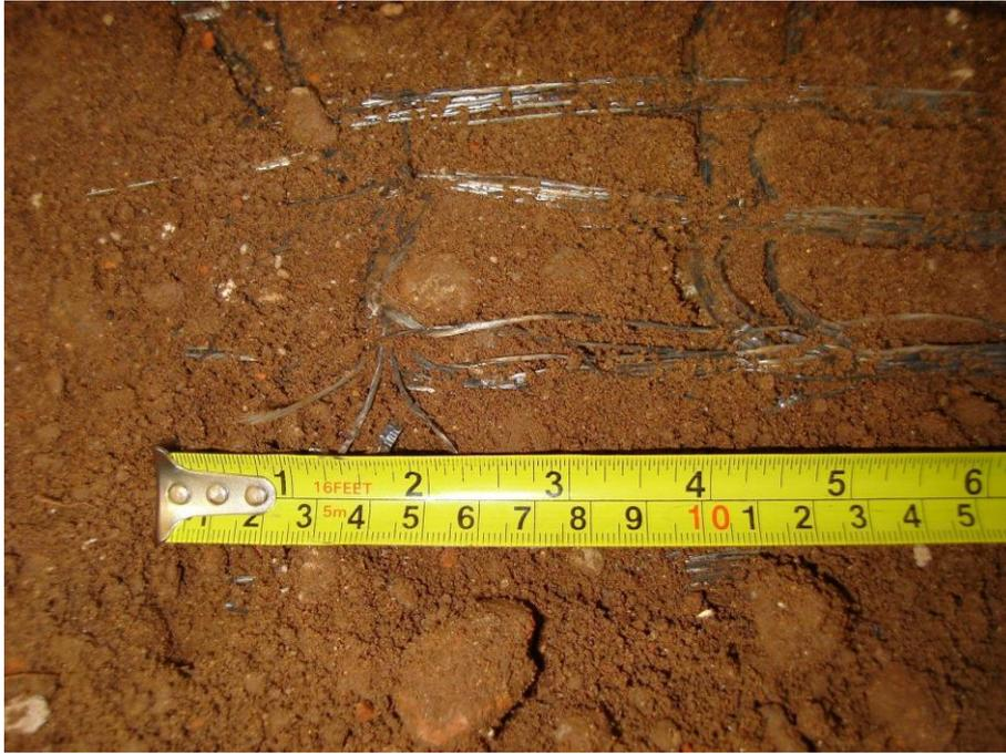
Figura 2.10 Ancoramento de membro transversal de geogrelha após o ensaio de arrancamento com RCD-R (Santos, 2007).
