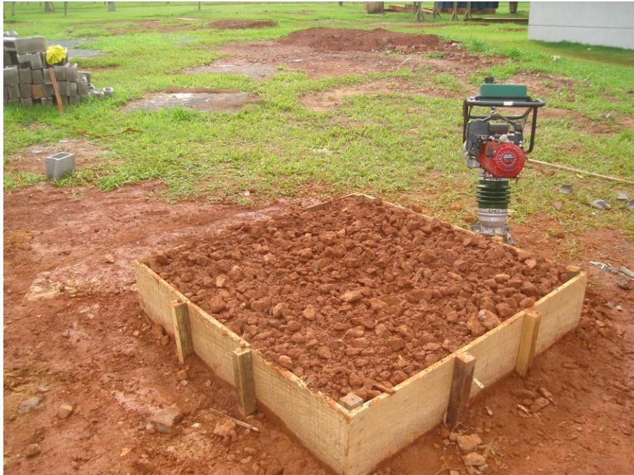
Figura 3.6. Caixa utilizada na reprodução do dano mecânico.
