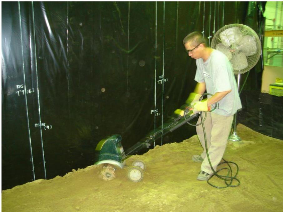
Figura 3.51. Processo de revolvimento objetivando a retirada de umidade do solo.
