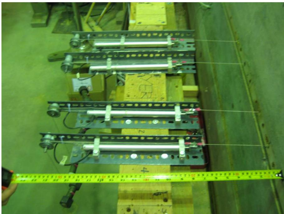
Figura 3.38. Transdutores de deslocamento instalados na parte traseira do Muro 3, para o monitoramento dos extensômetros de cabo de aço.
