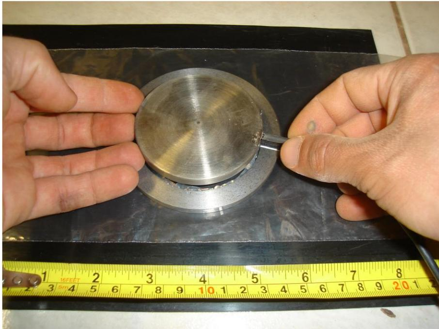
Figura 3.25. Instalação do anel de proteção da CTT.
