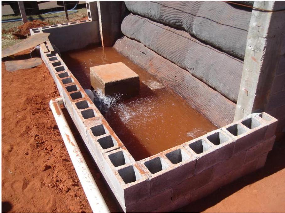
Figura 3.19. Detalhe da inundação da fundação dos muros experimentais.
