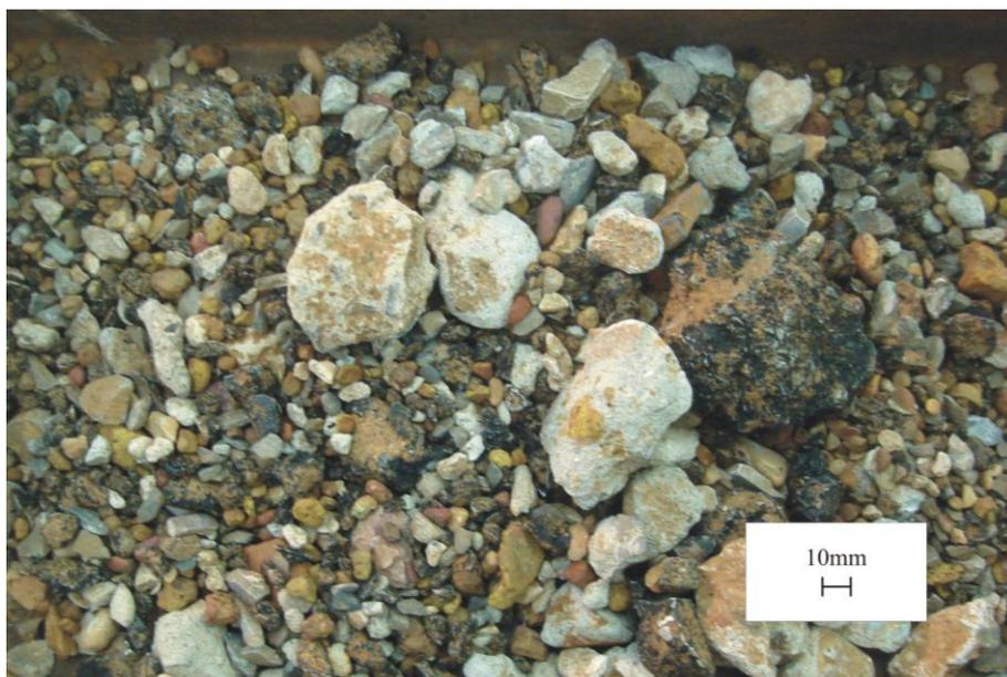
Figura 4.3. Material retido na peneira de abertura 4,8 mm (RCD-R 03)
