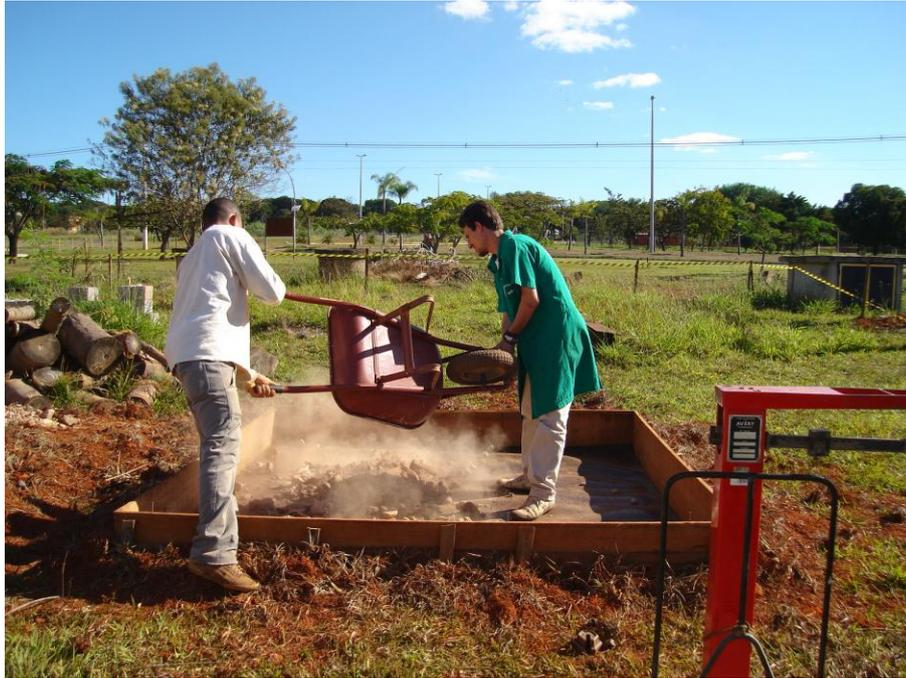
Figura 3.47. Lançamento do RCD-R na caixa de calibração e cubagem.
