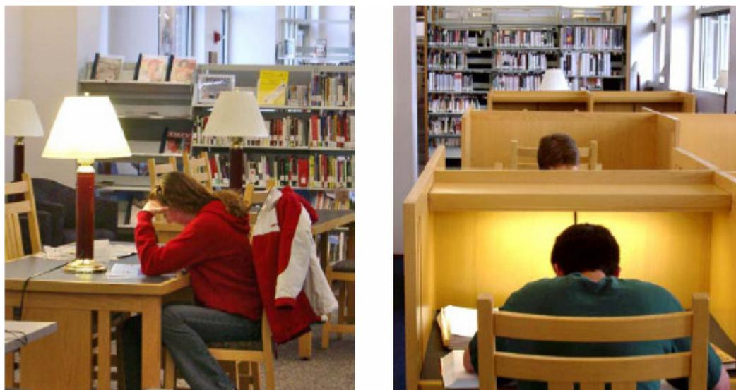
Figura 2.61 - *Harmony Library* - Iluminação de tarefa suplementa a iluminação geral. À esquerda as luminárias de mesa operadas por temporizador, e à direita as cabines de estudo acionadas por interruptor manual simples. (fonte: Daylight Dividends <<http://www.lrc.rpi.edu/programs/daylighting/pdf/HarmonyLibraryCaseStudy.pdf>>. Acesso em 24/11/2007).
