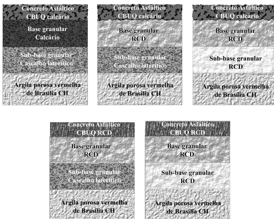
Figura 5-14. Estruturas avaliadas na análise empírico-mecanística, de esquerda para a direita: a) estrutura convencional; b) estrutura com base de RCD; c) estrutura com base e sub-base em RCD; d) CBUQ e base em RCD; e) estrutura em RCD.
