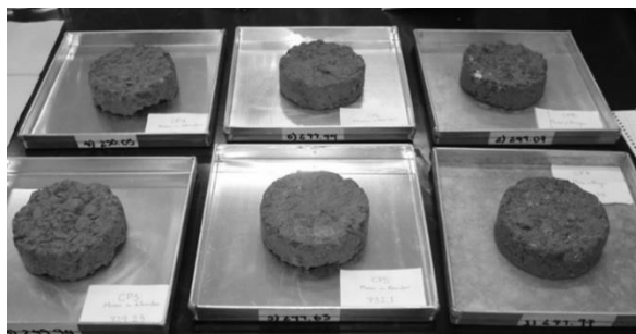
Figura 3-6. Corpos de prova em processo de secagem para ensaio de sucção pelo método do papel filtro.
