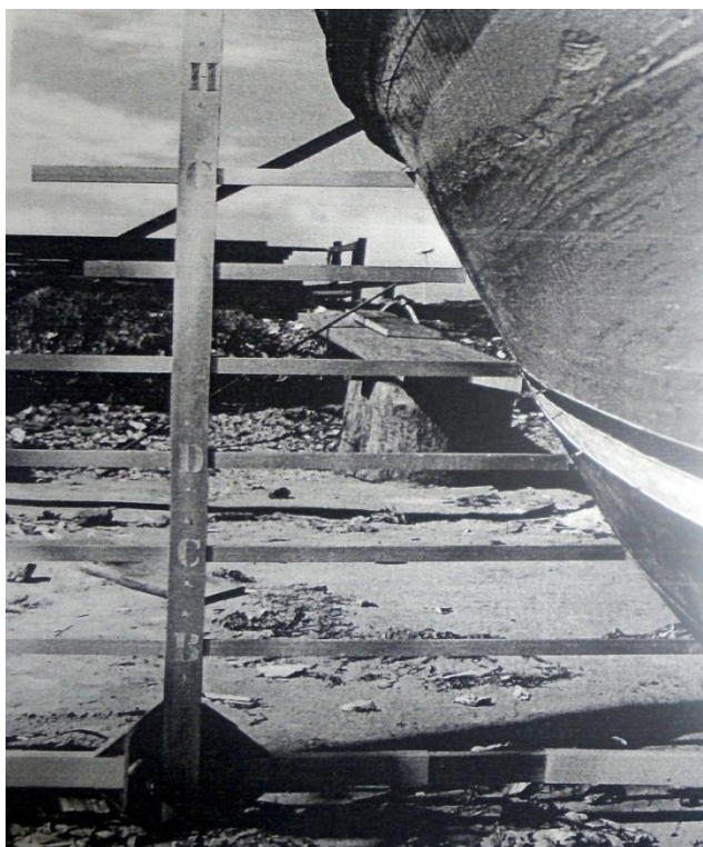
Figura 16 - O cavernômetro, no detalhe. Fotografia do Acervo do PEM (Andrés, 1986).
