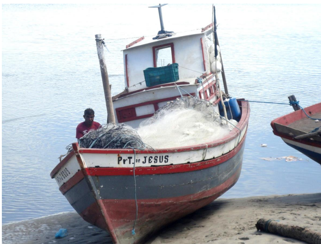
Figura 15 - Bote Proa de Risco em Raposa/MA (janeiro de 2010). A estrutura da embarcação segue detalhes de linhas curvas em todas as dimensões (a exceção da cabine do convés que pode até variar de acordo com a necessidade de utilização).
