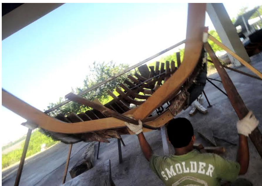
Figura 47 - Mestre Otávio conferindo a harmonia das formas das cavernas 'no olho'. CVT Estaleiro Escola do Sítio Tamancão, 2013.
