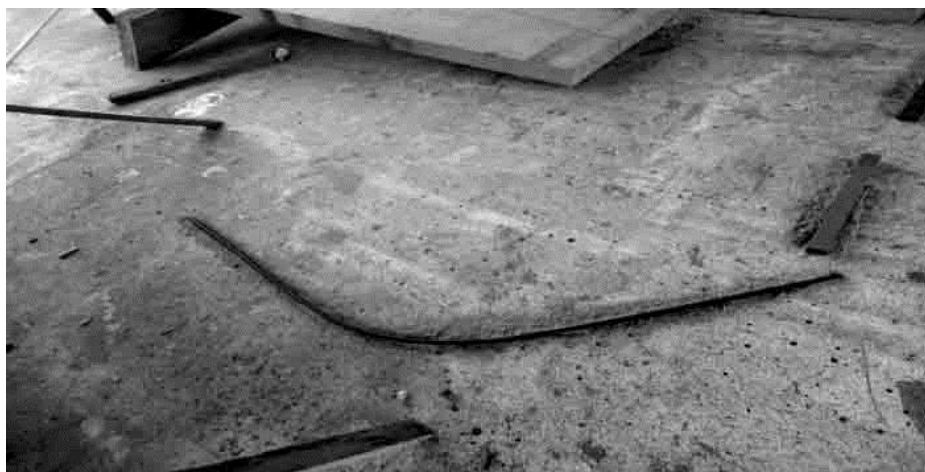
Figura 33 - Vergalhão de ferro (fôrma de arame) que serve de referência para a marcação a lápis do local de corte das cavernas.
