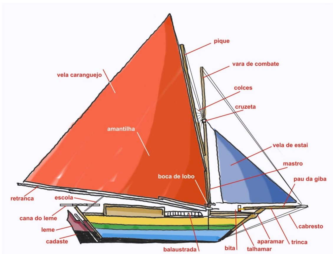
Figura 52. Ilustração da canoa costeira. Partes da canoa no detalha.
