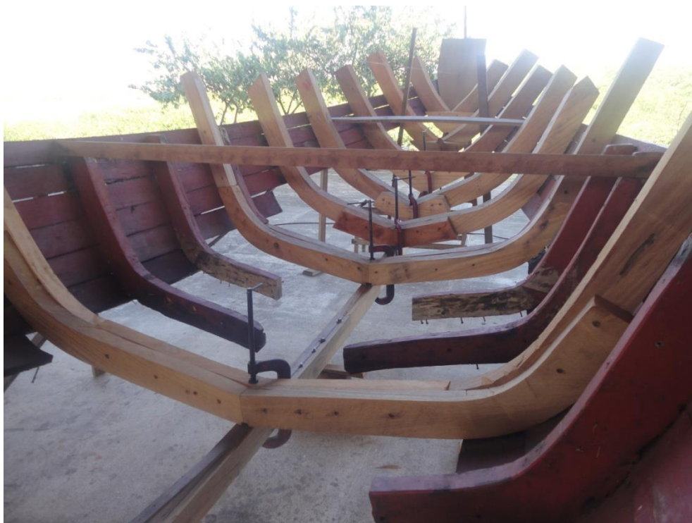
Figura 10 - Cavernas sendo fixadas à quilha na reforma de uma biana no Estaleiro Escola do Sítio Tamancão, São Luís/MA
