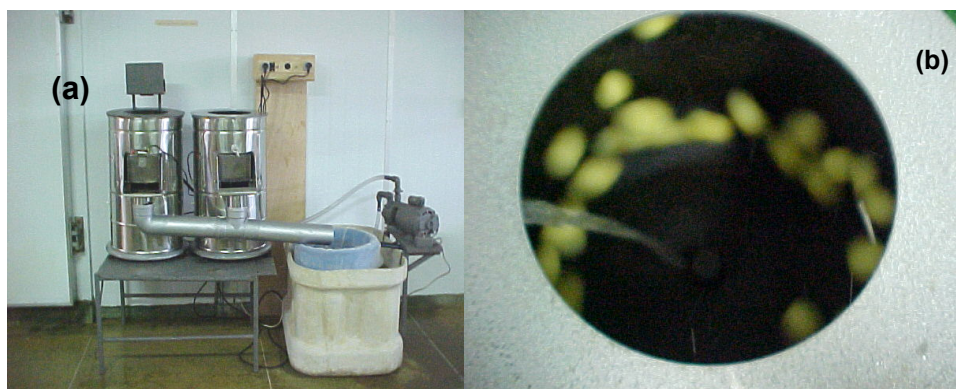
Figura 1. Máquina processadora (modelo PCED) (a). Batatas no momento do descasque por abrasão no tambor rotativo. Embrapa Hortaliças, Brasília, DF, 2004 (b).
