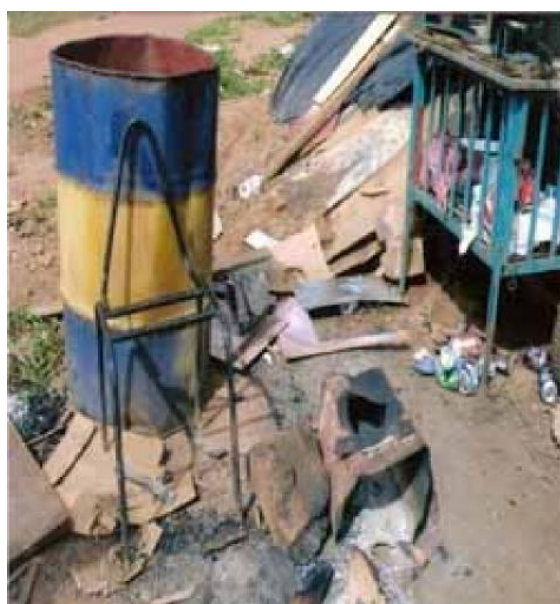
Fig. 10 - Fogão feito com lata recortada. Foto: Anelise W. Ferreira. Ano: 2006.
