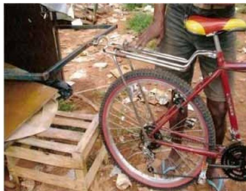
Fig. 48 - Detalhe do acoplamento da bicicleta ao carrinho-casa-dormitório. Foto: Sainy Veloso. Ano: 2006.
