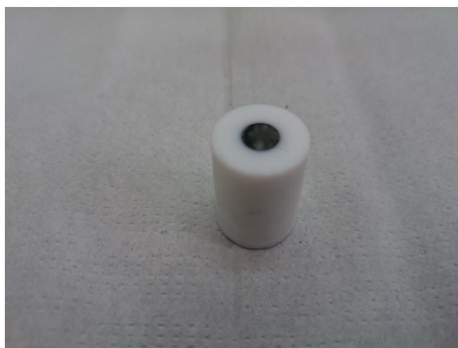
Figura 30. Imagem do eletrodo de trabalho de carbono reticulado vítreo feito em Teflon.
