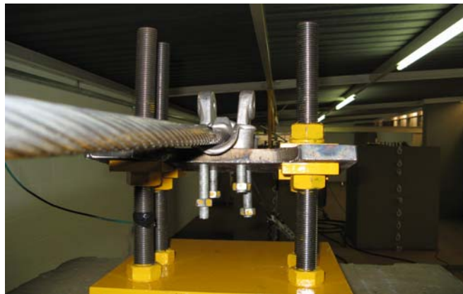
Figura 7.5 – Montagem do corpo de prova no grampo de suspensão.
