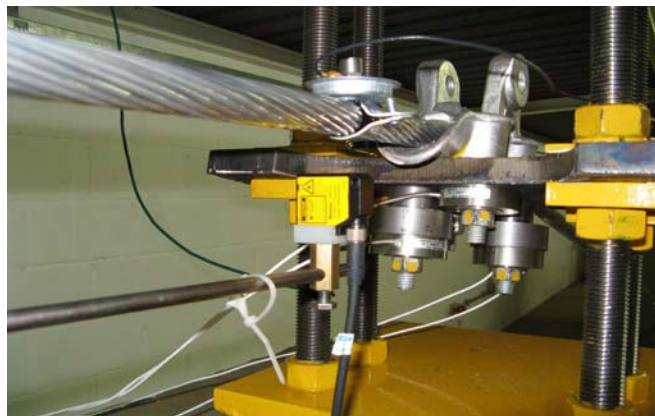
Figura 7.10 – Posicionamento do sensor a laser a 89 mm da “boca” do grampo de suspensão.
