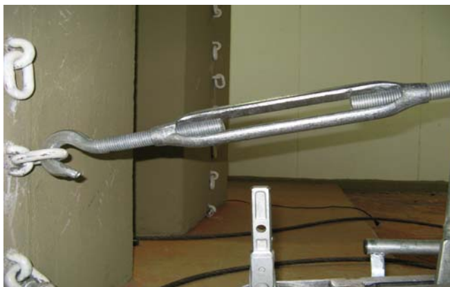
Figura 7.7 – Montagem do corpo de prova na Bancada (fixação final do vão passivo no bloco de ancoragem).
