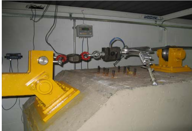
Figura 5.5 - Célula de carga, grampo de fixação, e polia de apoio do cabo.
