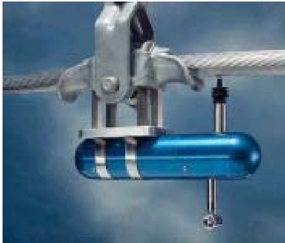
Figura 4.5 – Foto de um vibrógrafo instalado junto ao grampo de suspensão [CIGRE].
