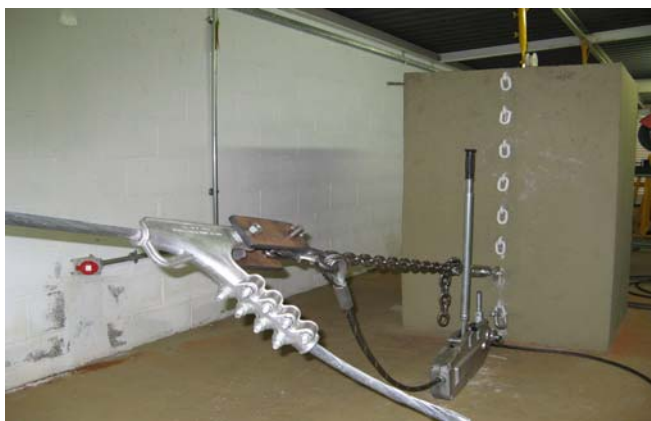
Figura 7.6 – Montagem do corpo de prova na Bancada (na extremidade do vão passivo).
