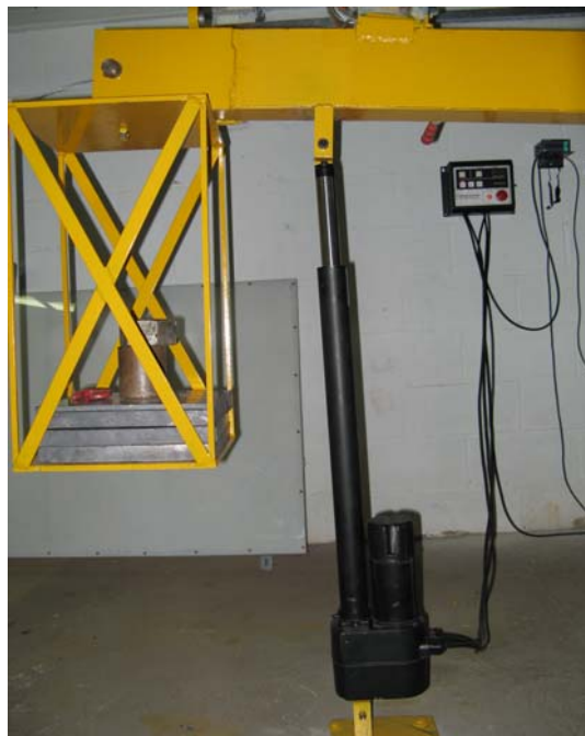
Figura 7.15 – Instalação do atuador linear no braço de alavanca.
