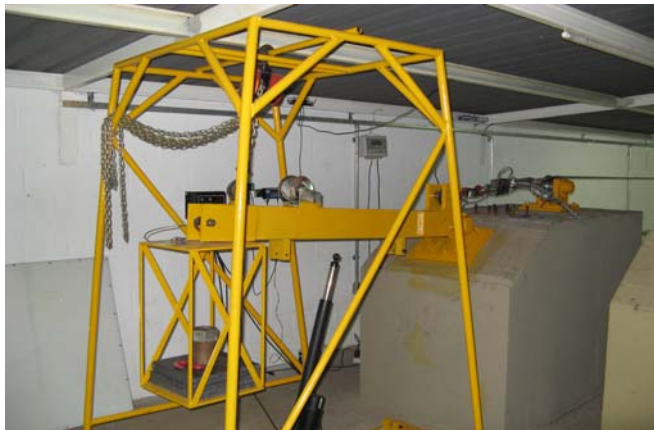
Figura 5.3 - Braço de alavanca com sistema de contrapeso, atuador linear e célula de carga acoplada ao grampo de fixação (vão ativo).
