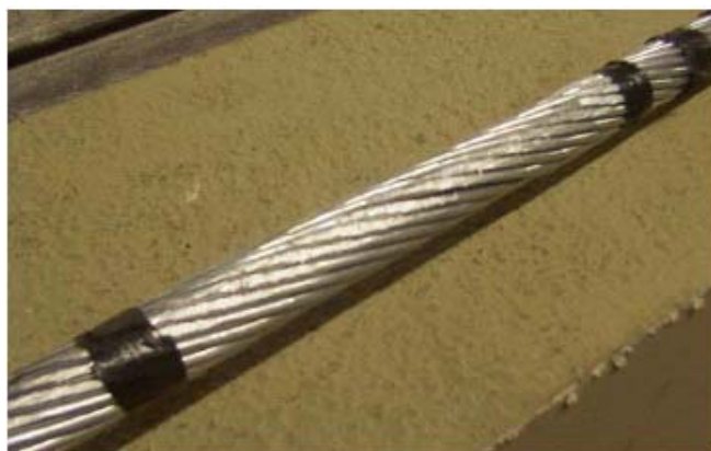
Figura 6.11 – Estado final do cabo ensaiado com amplitude de 1,1 mm durante 1 \cdot 10^5 ciclos.
