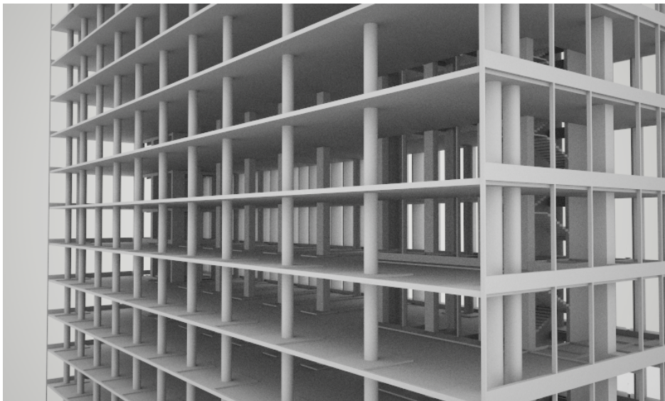
Figura 308 – Visão geral dos pavimentos. Perspectiva estrutural do MESP. Estrutura em concreto armado do MESP conforme projeto estrutural de Emílio H. Baumgart. Fonte: Autor. 2015.
