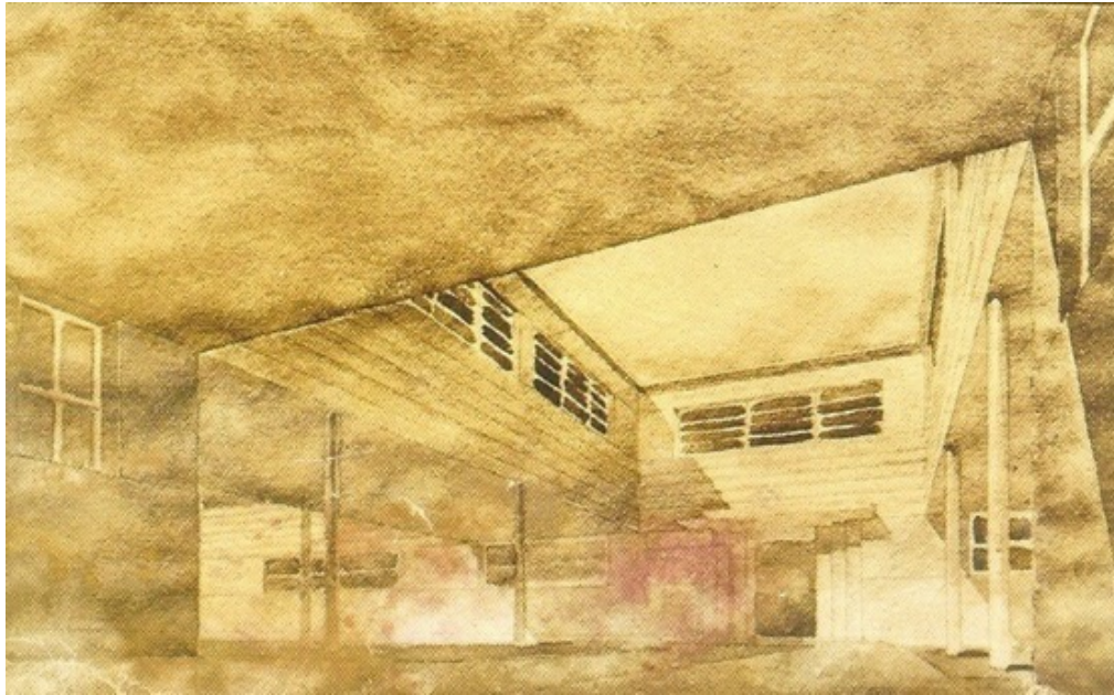
Figura 272 – Versão original: pátio vazado e pavimento superior sustentado por pilotis. Perspectiva do arquiteto. Fonte: Bonduki, 1999.
