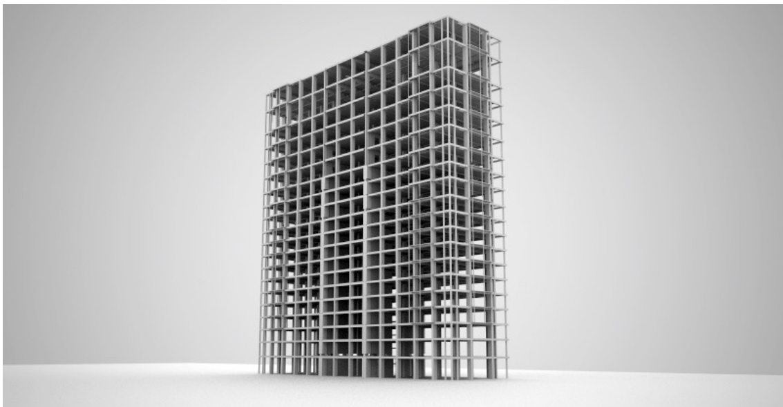
Figura 247 – Estrutura tridimensional do Edifício A Noite em concordância com as plantas estruturais originais do edifício. Modelo realizado pelo autor. FONTE: SEEBLA, 2014 e PAMPONET, 2015
