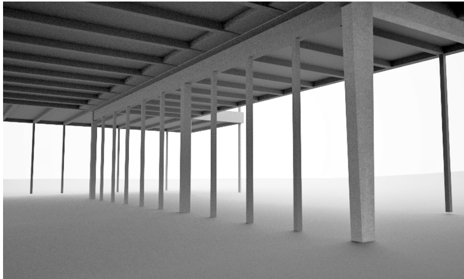
Figura 282 – Vão da administração mostrando a variação nos elementos estruturais. Viga corrida com variedade formal, pilares principais com diminuição de base e grelha da recepção como ambiente adjacente. Fonte: Autor, 2014.
