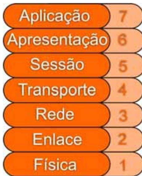
Figura 2.3: Modelo OSI de camadas
